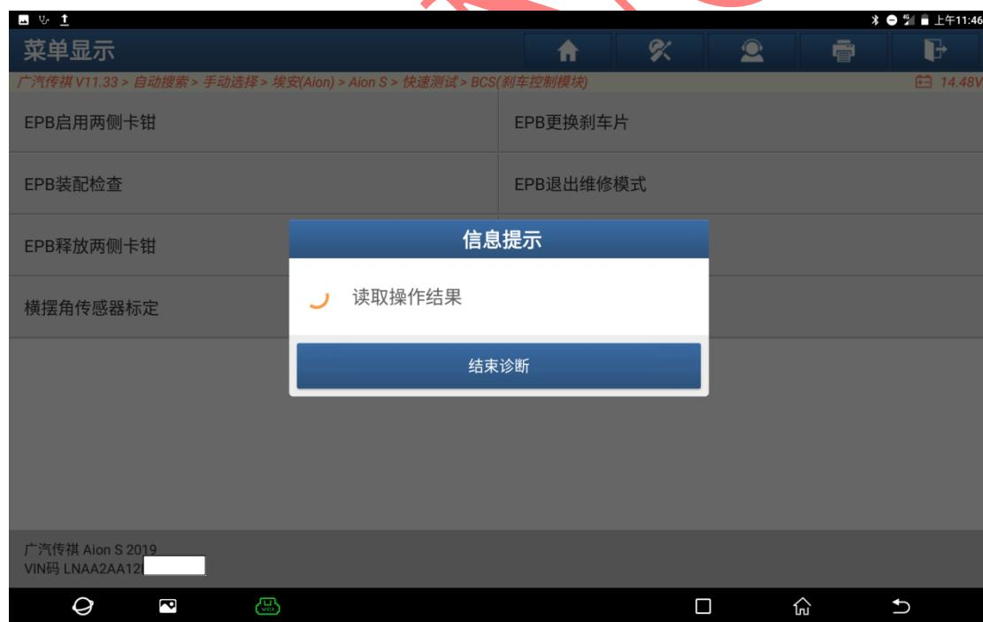
8. 提示“分泵已成功释放，关闭点火开关，可以执行维修操作”，维修完成后执行【EPB 退出维修模式】，点“确定”（如下图）；
