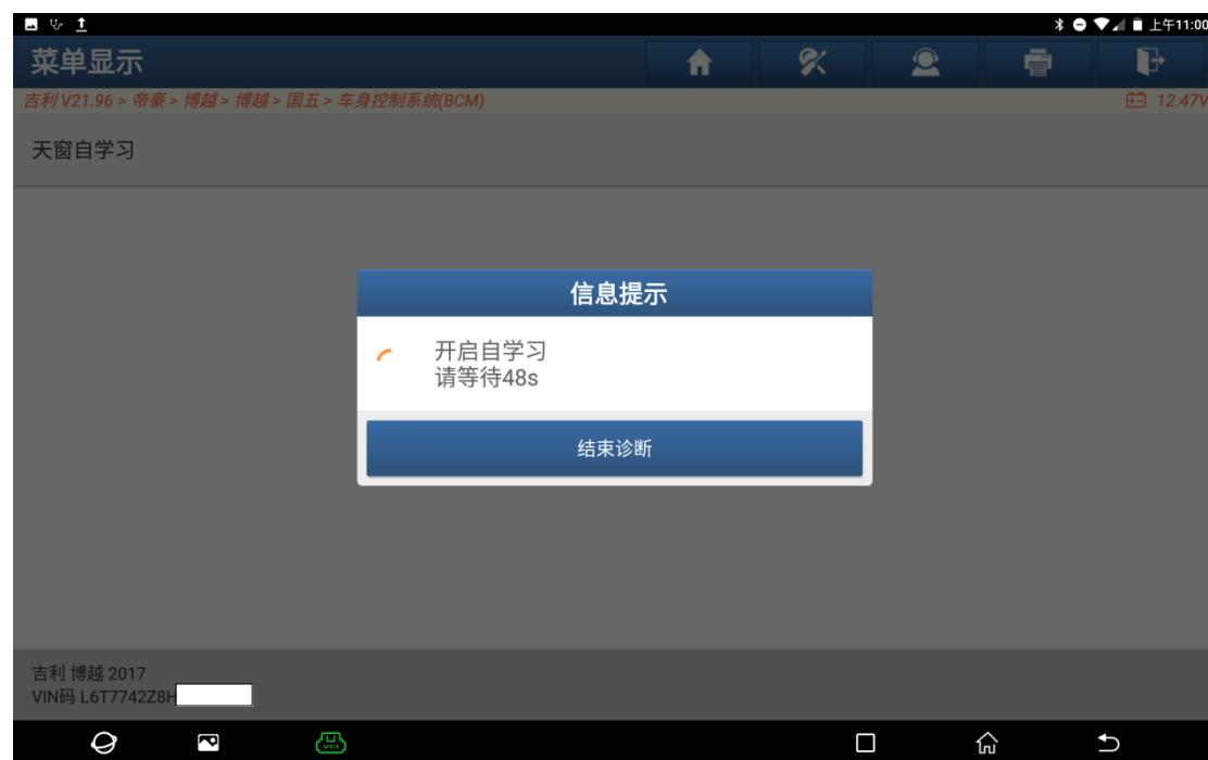
11. 等待结束后，执行清码功能，重新读取故障码，显示正常无码，点“确定”，学习结束 (如下图)。
