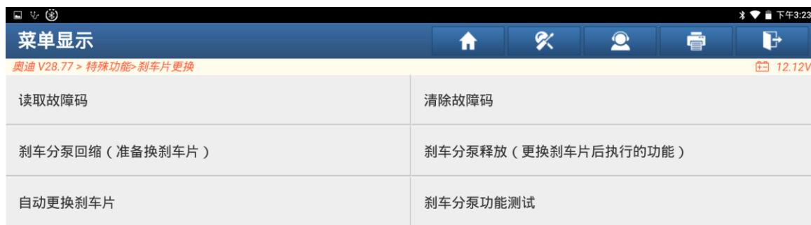
9. 点击刹车分泵释放（更换刹车片后执行的功能）。
