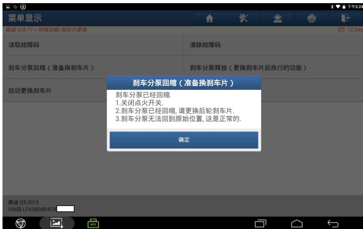
8. 关闭点火开关，点击“确定”。拆下旧的后刹车片，更换新的后刹车片。打开点火开关，
