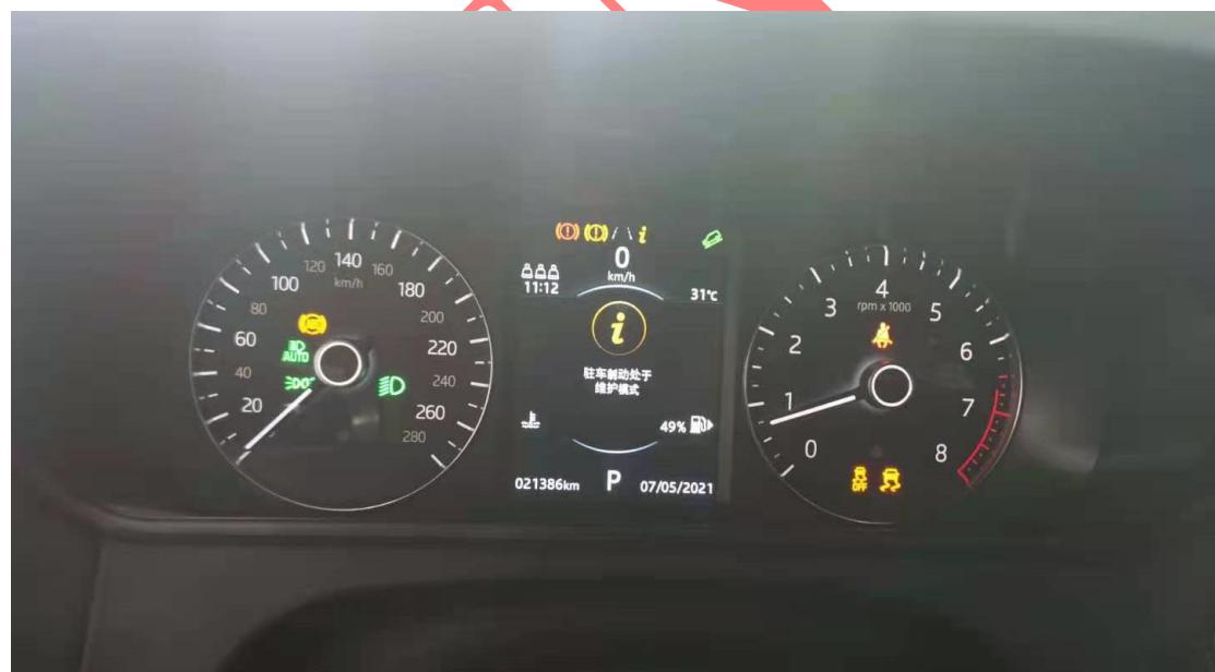
12. 维修完成后, 执行【更换驻车制动片-退出维护模式】(如下图);
