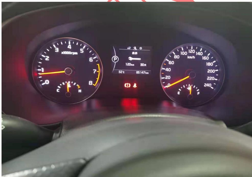
2. 更换机油后选择【X431-PRO】设备，选择【悦达起亚】车型，连接进入后选择【自动搜索】识别车辆（如下图）；
