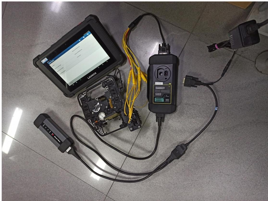
4、点击【连接】，在读取出了原车变速箱的芯片 ID 之后点击【确定】，如图所示：
