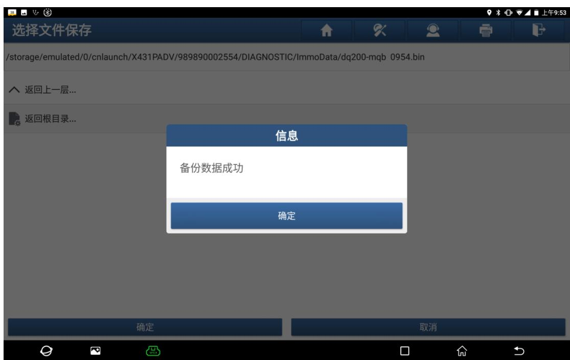
6、外来波箱装车，设备连接到汽车诊断座，退出特殊功能，进入传统诊断，选择大众车系，选择【特殊功能】，选择【防盗功能】，点击【确定】，进入防盗系统主菜单后，选择【MQB仪表】，点击【确定】后选择【部件更换】，选择【变速箱】，点击【确定】，点击【是】，进入变速箱更换界面，如图所示：
