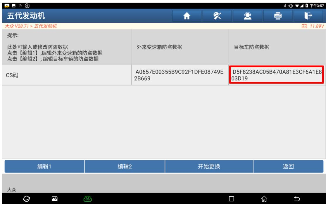
9、点击【开始更换】按钮，依次输入原车的VIN码、功率等级以及原车仪表的CS码，便能完成变速箱的更换，如图所示：(注：如果第8步骤，选择【原车钥匙获取】，读到原车数据，就不需要手动输入VIN码，功率等级和原车仪表CS码，都自动获取往下执行)
