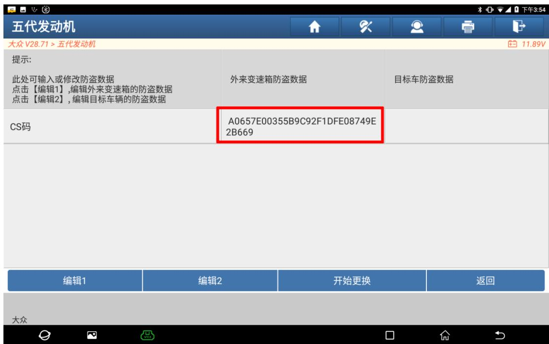
8、点击【编辑 2】，如果是从其他设备获取了原车变速箱的相关数据，则选择【手动输入数据】，输入原车变速箱 16 字节的 CS 码，如下图所示：(注：如果没有目标车的防盗数据，则选择【原车钥匙获取】，将该变速箱的原车钥匙放到防盗编程器中，按照信息提示往下执行，也可读取操作。)
