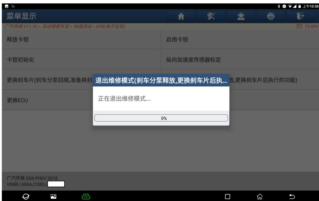
15、释放完成后，仪表提示的“电子驻车测试中”与驻车维修灯会消失，释放操作结束（如下图）。
