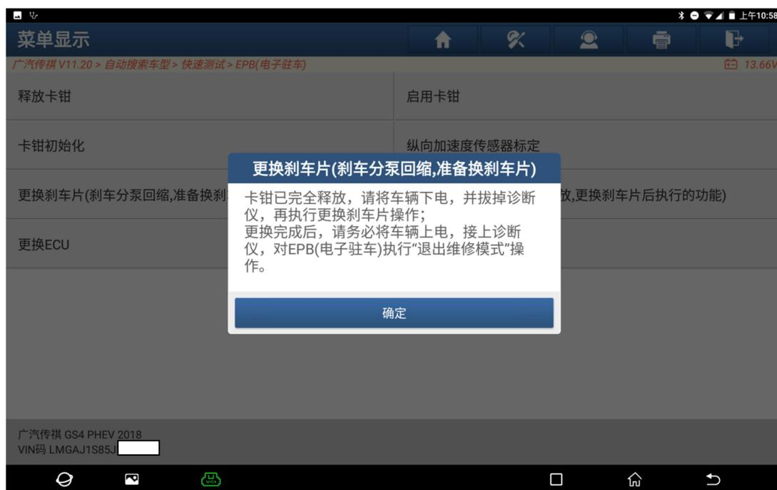
10、分泵回缩成功，仪表会提示“电子驻车测试中”，同时驻车维修灯会亮起（如下图）；
