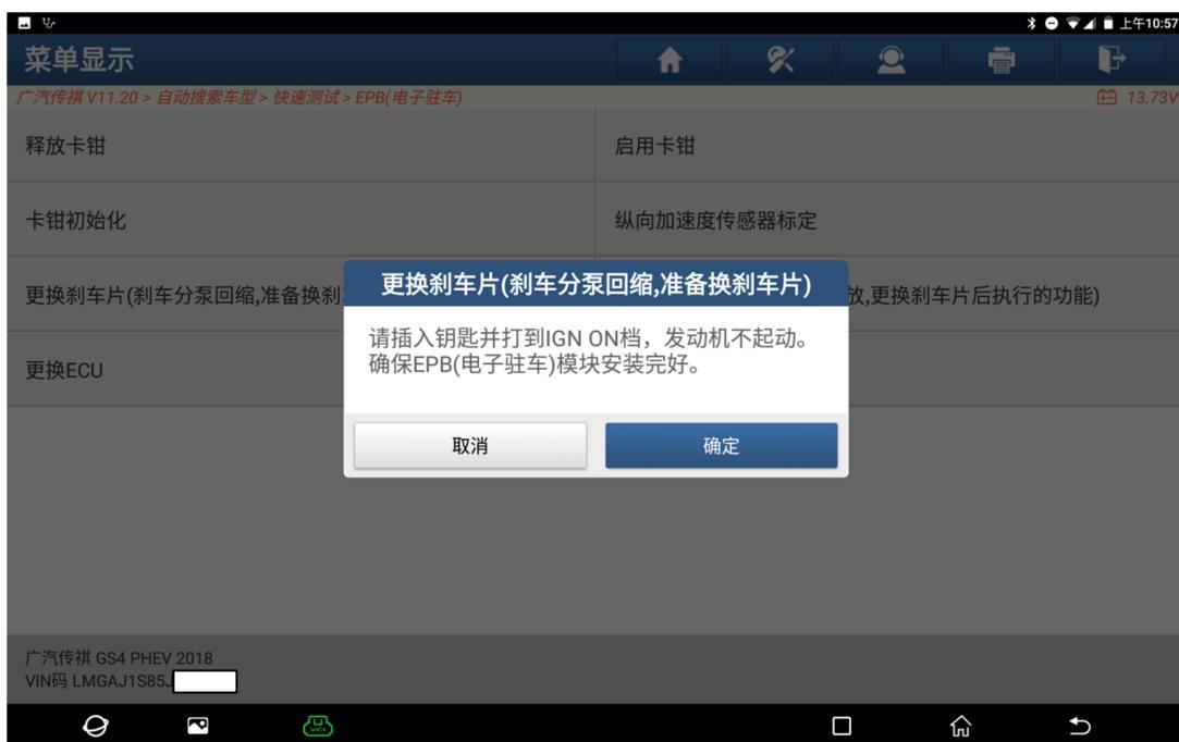
7、满足条件“车辆停放平整的地面，松开电子手刹”，然后点“确定”（如下图）；
