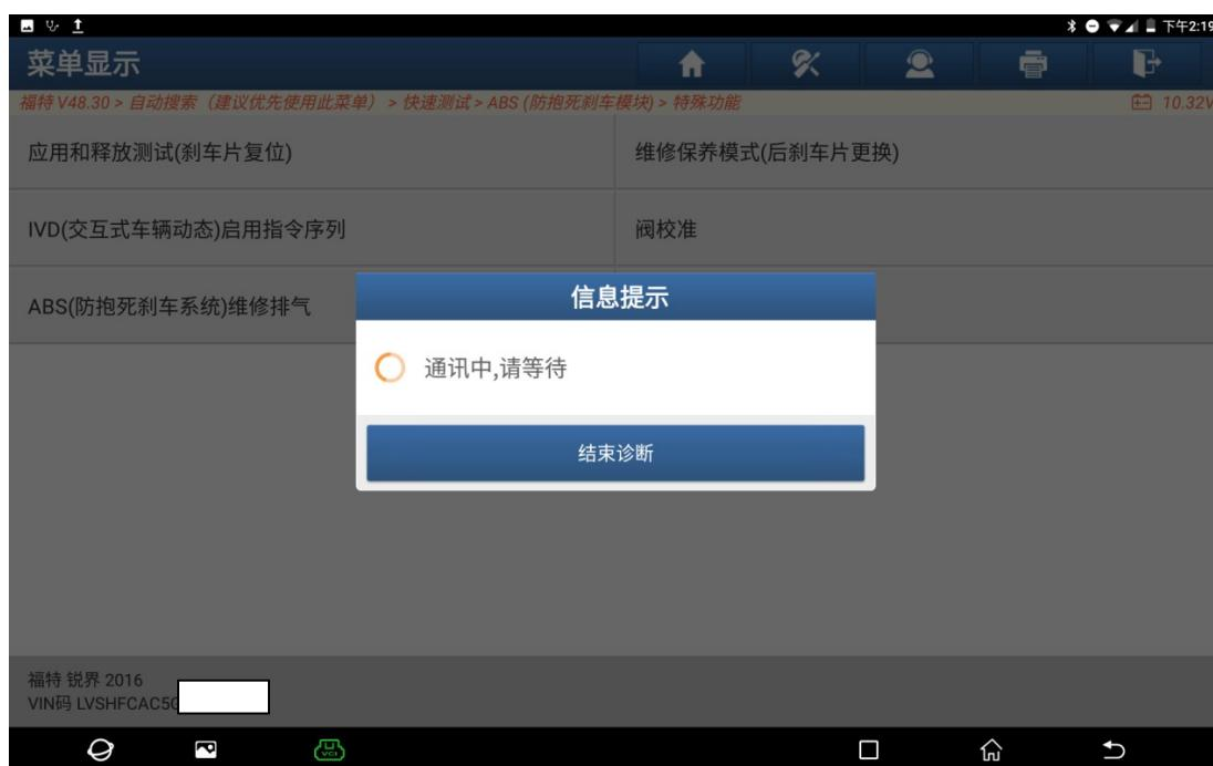
8、点“确定”可以执行后轮的维修保养（如下图）；
