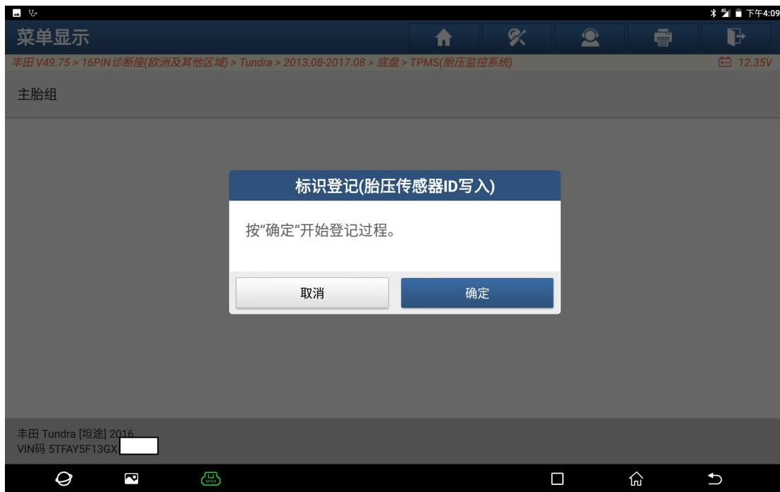
6、按“确定”后，有 5 分钟的时间来进行下列操作，输入每个发射器标识代码，按“确定”输入另一个代码，继续操作，直到所有登记完毕(如下图)；
