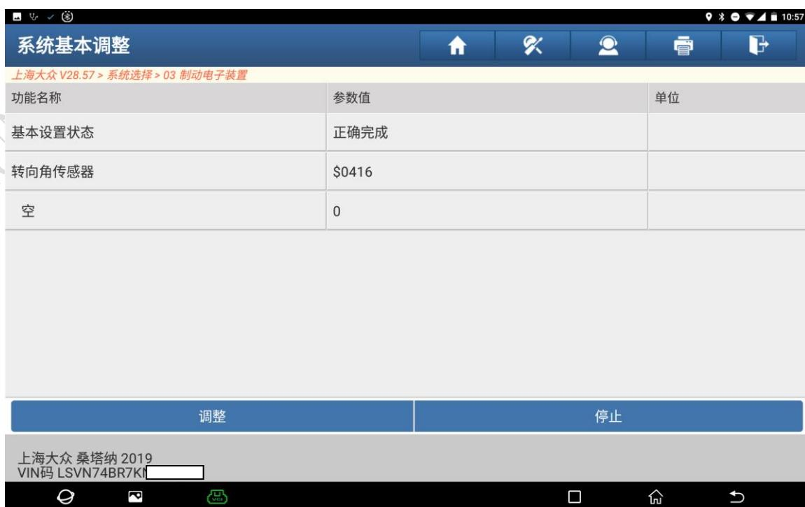
完成 03 系统的转向角基本调整后再对 03 以及 44 系统执行清码以及读码，此时大部分情况 03 系统以及 44 系统的故障码都已被清除，若 44 系统中还存在“B116854 转向角传感器-无基本设置”的故障码，则进入 44 系统执行基本调整，操作过程与 03 系统的一致，区别只在于 44 系统的安全登录码应为“19249”，操作见下：
