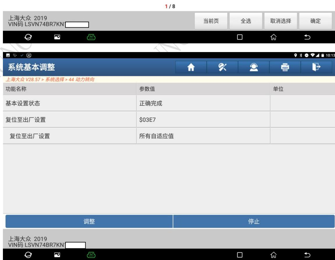
5、执行完“复位至出厂设置”后，“44 助力转向系统”会存储以下故障码，继续执行后面的操作来清除这些故障码。
