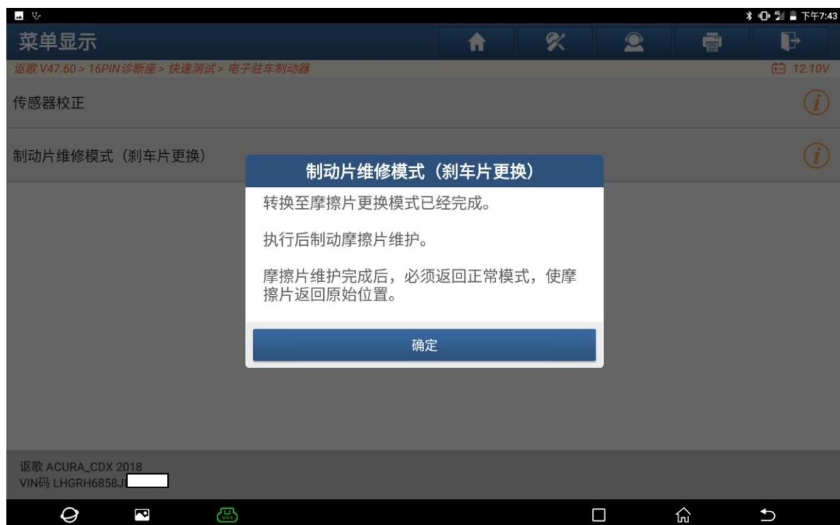
10、 维护完成后执行“返回正常模式”，点“确定”（如下图）；
