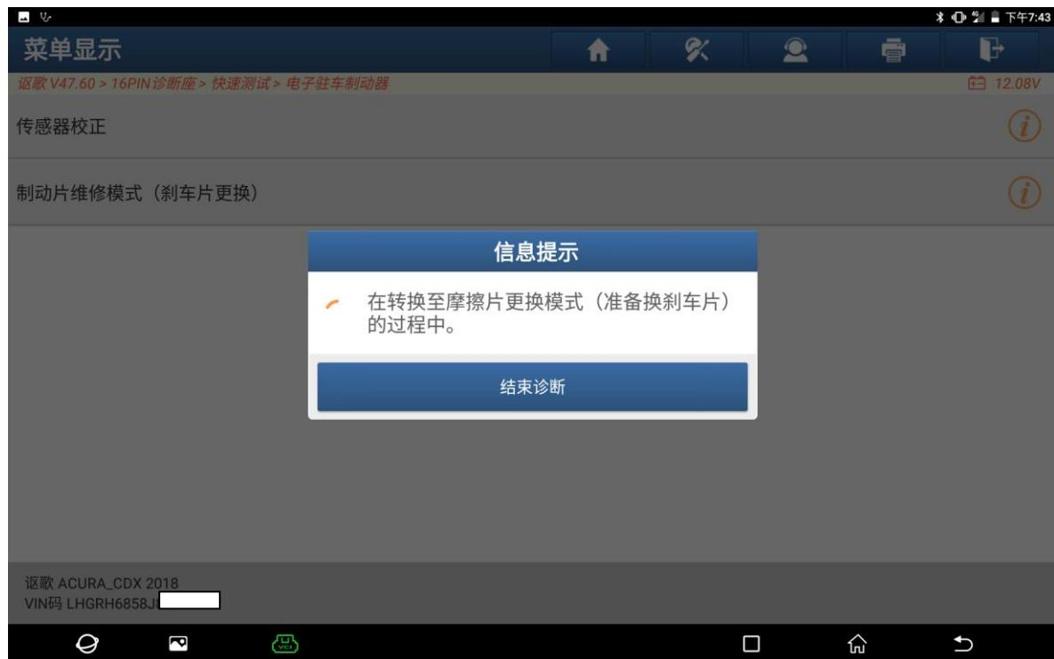
9、提示“模式转换完成，可以执行维护，维护完成后需返回正常模式”，然后点“确定”开始维护（如下图）：
