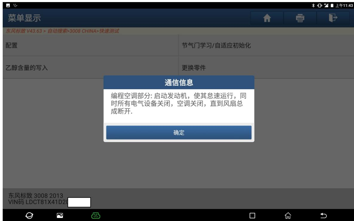
13、 满足条件“踩油门，发动机转速加速到 5000 转后松开”，然后点“确定”（如下图）；
