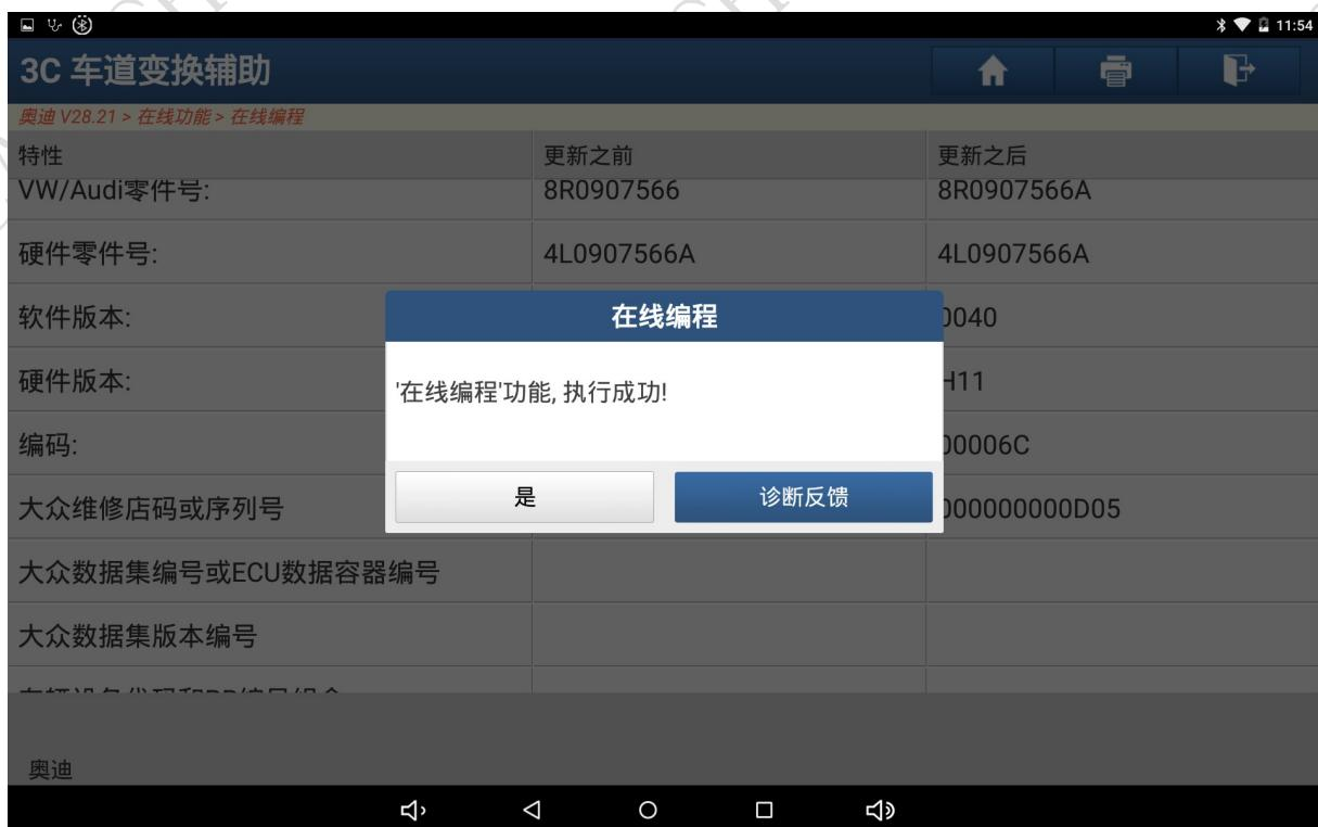
9、系统选择进入 3C 系统读故障码，此时故障码已经清除成功。变道辅助模块能正常启用，操作结束。
