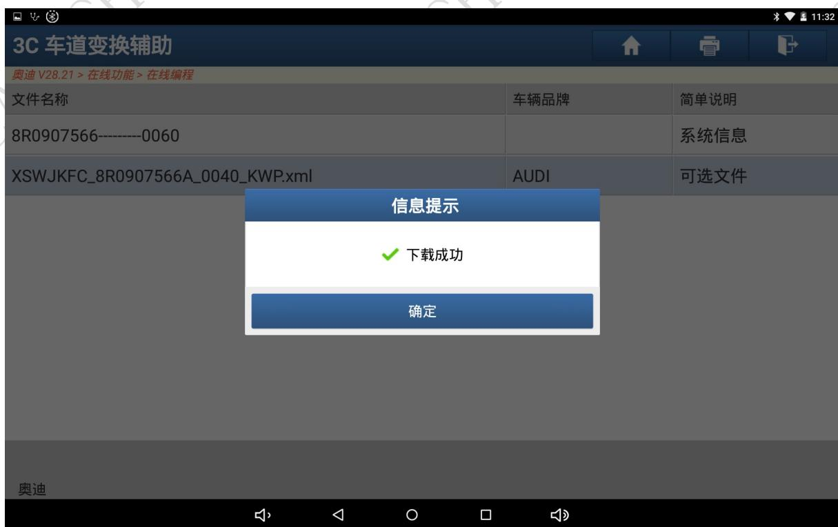
7、文件下载完成后接着点确定，开始执行 ECU 刷写过程，刷写时间需要 20 分钟左右，请耐心等待。
