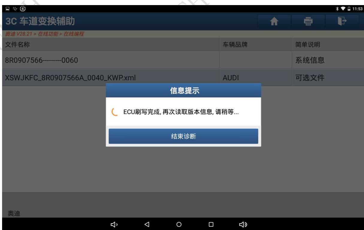
8、刷写完成后清除故障码，再次读取版本信息，在线编程成功完成。
