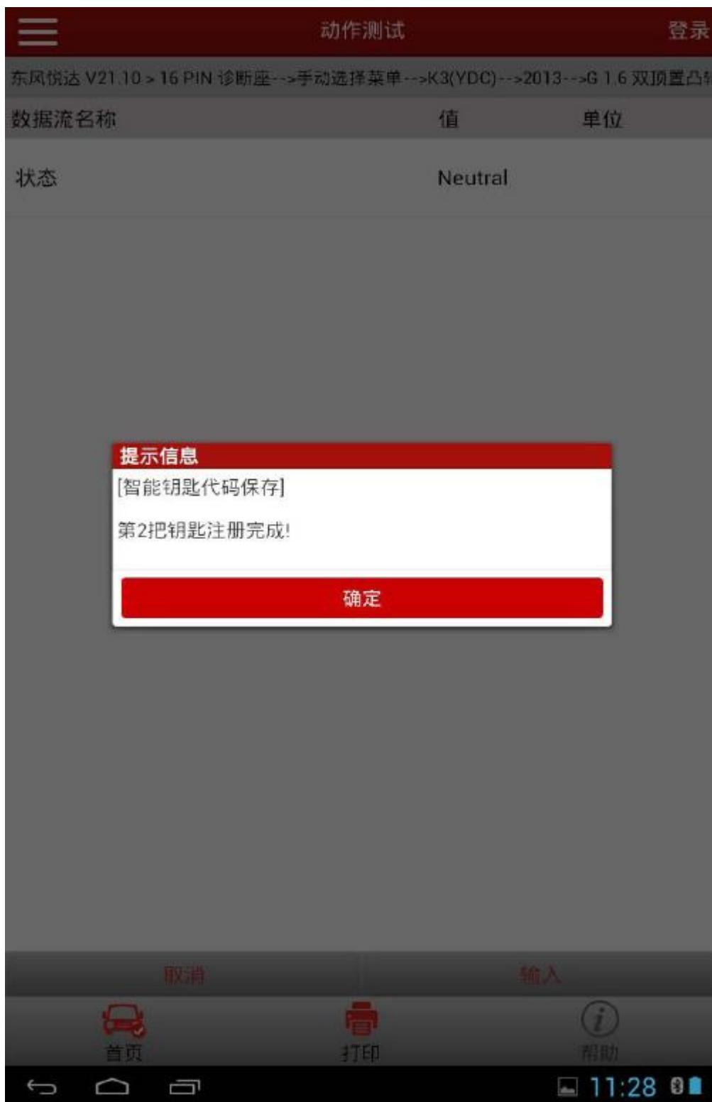
7). 到此为止2 把钥匙都已经完成匹配了。接下来诊断仪会继续询问汽车ECU 刚刚注册的钥匙数量等相关信息，如下图：
