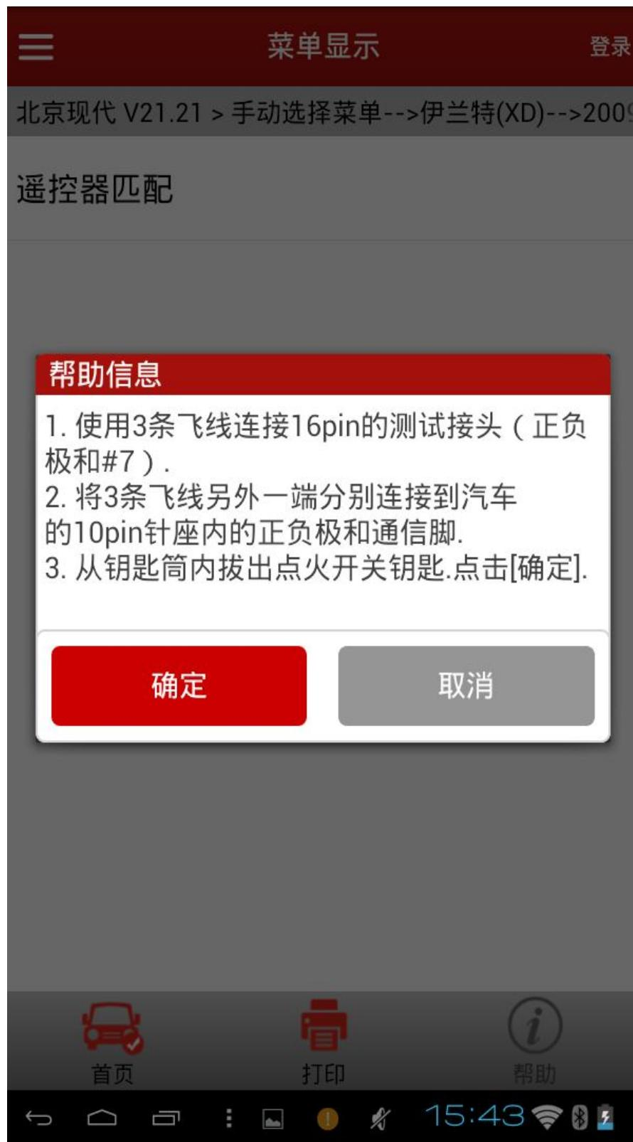
3). 根据提示先拔出点火钥匙，然后按下确认[OK]，接下来诊断仪会显示如下图所示界面，此时一定要根据匹配步骤进行操作。
