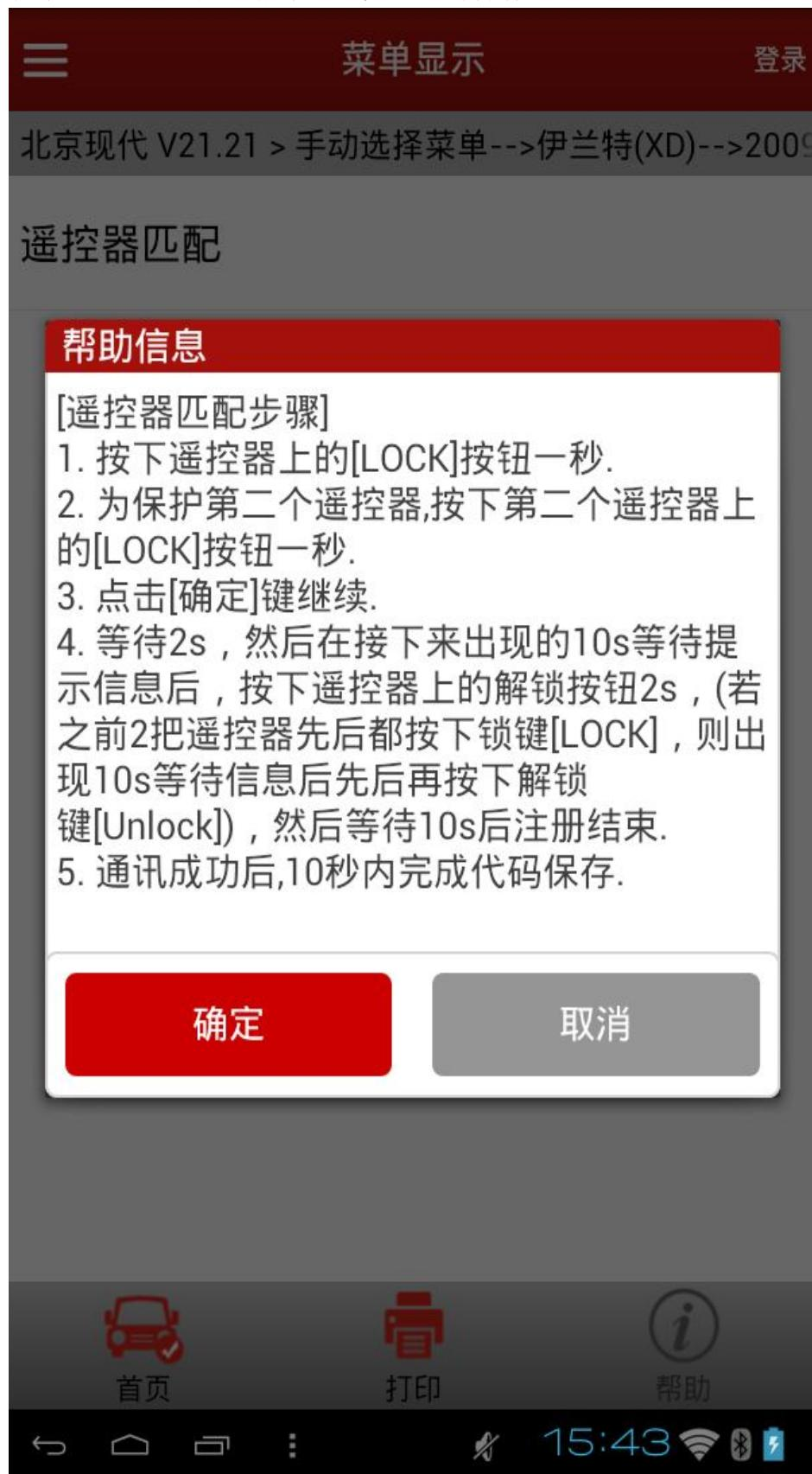
4). 软件提示如下图所示代码保存信息，等待 2 秒，然后按下遥控器上的解锁按钮 2 秒（若之前 2 把遥控器先后都按下锁键[LOCK]，则提示下图信息后，先后按下 2 把遥控器上的解锁键[Unlock]）。大概等待 10 秒后提示匹配结果。
