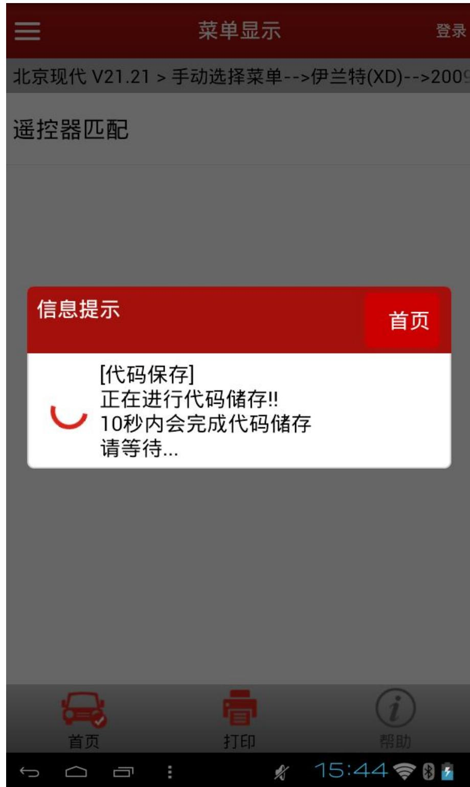
5). 匹配完成, 如下图所示。注意在匹配结束后, 当确认遥控器是否工作时, 不能使用钥匙插入钥匙孔。
