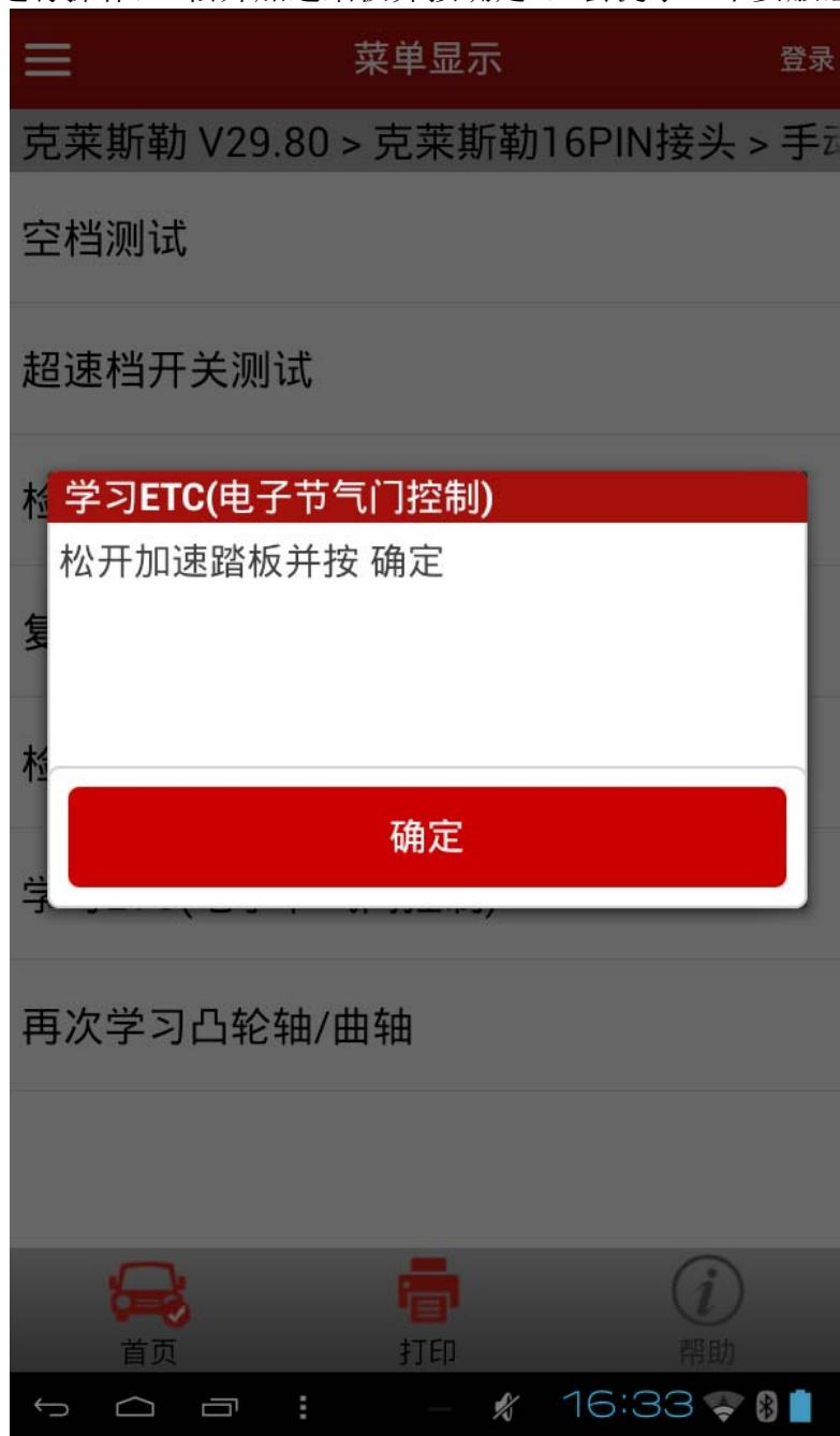
9). 提示“学习ETC(电子节气门控制)”成功，确定之后，退出软件，关闭点火开关。
