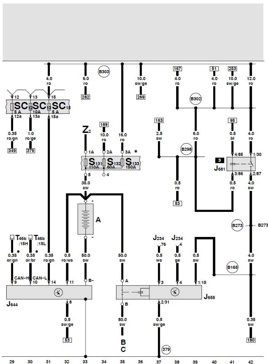
蓄电池、蓄电池监控装置控制单元、蓄电池断路器、总线端 KI.15 供电继电器 -2-
