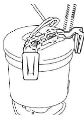
E). 用端部缠绕保护带的螺丝刀，脱开5个定位爪，并从燃油滤清器上拆下燃油泵滤清器和燃油泵。
