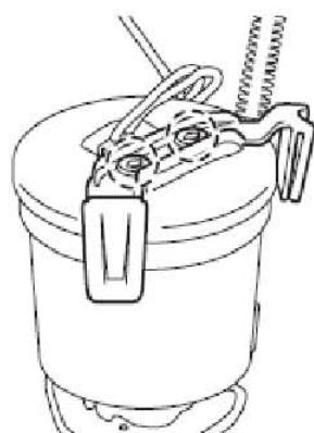
E). 接合燃油吸入端支撑件上的2个定位爪，然后将燃油滤清器和燃油泵安装到燃油副油箱上。
