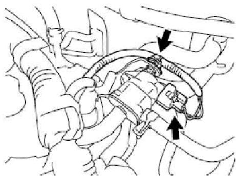
B). 断开2条软管，拆下占空比控制型真空开关阀。
