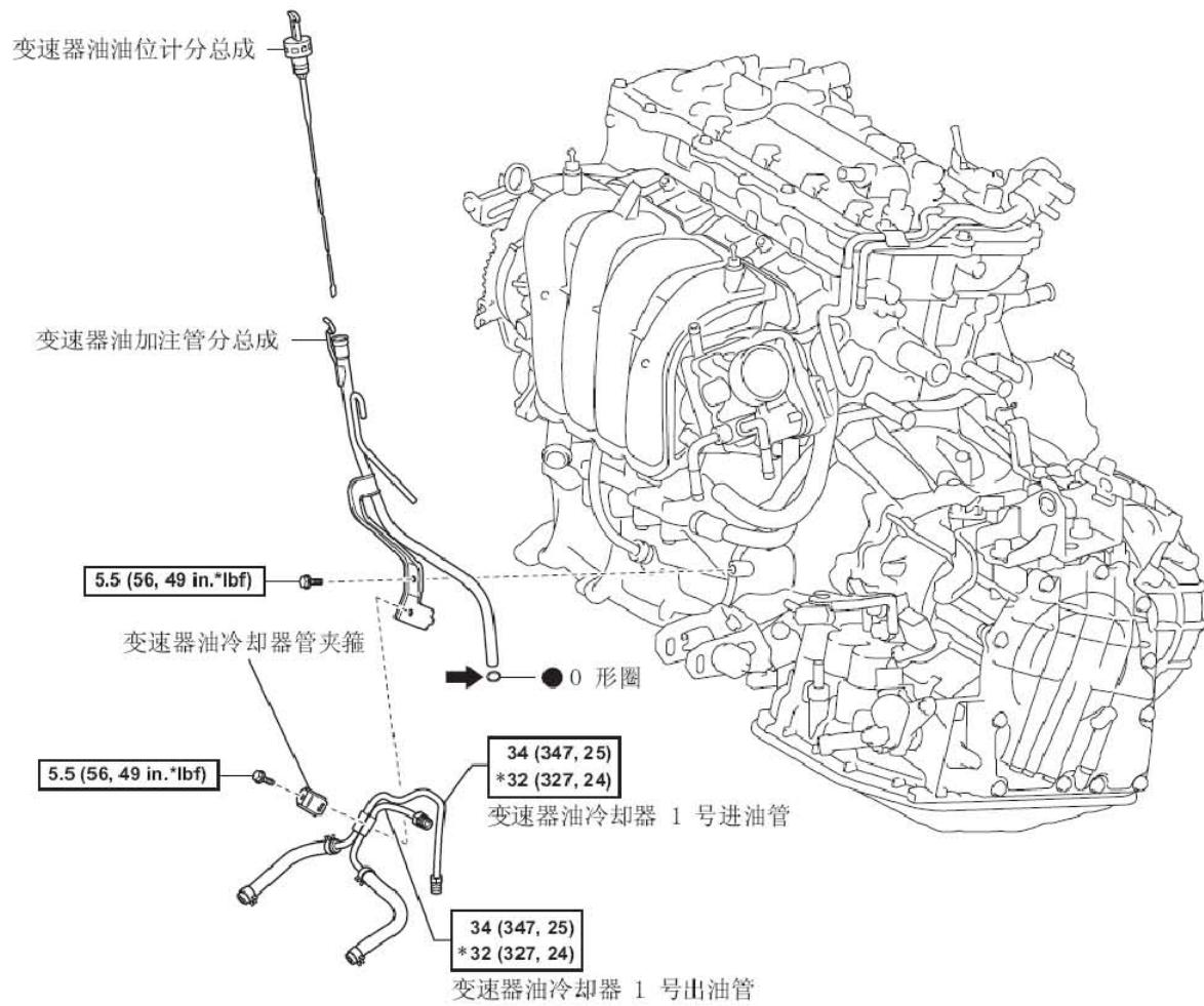
**N\*m (kgf\*cm, ft\*lbf)** : 规定扭矩 \* 用管接螺母扳手 ● 不可重复使用的零件 ← ATF
