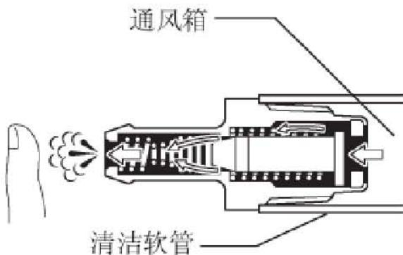
(b). 将空气吹入进气歧管侧，检查并确认空气较难通过。如果结果不符合规定，则更换通风阀。
