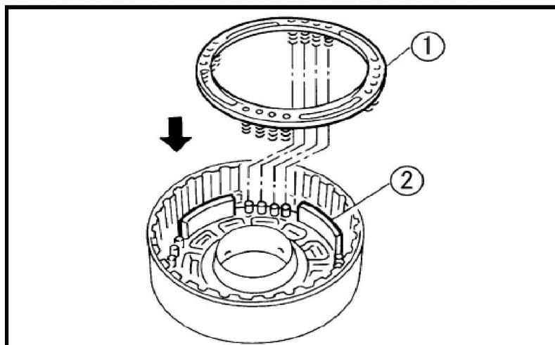
4). 将专用维修工具[SST] 置于弹簧座总成上，在压缩弹簧座总成时安装卡环。
