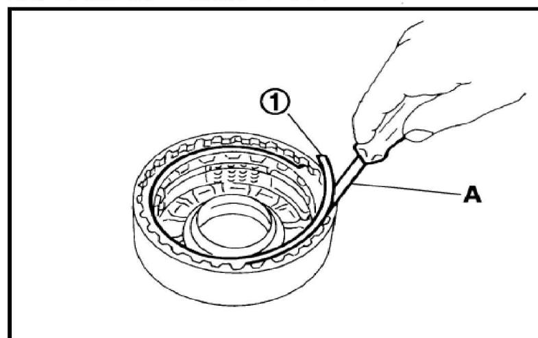
7). 使用塞尺测量挡片与卡环间的间隙。如果超过允许极限，选择合适的挡片。
