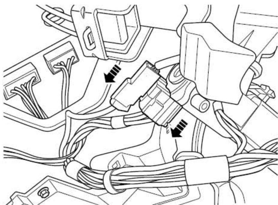
3). 连接钥匙忘拔开关、点火开关线束连接器。
