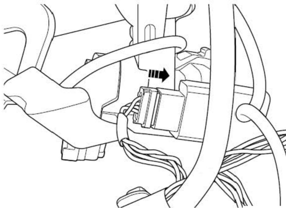
4). 连接电子防盗线圈线束连接器。
