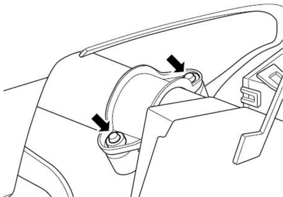
2). 安装点火开关固定螺栓。
