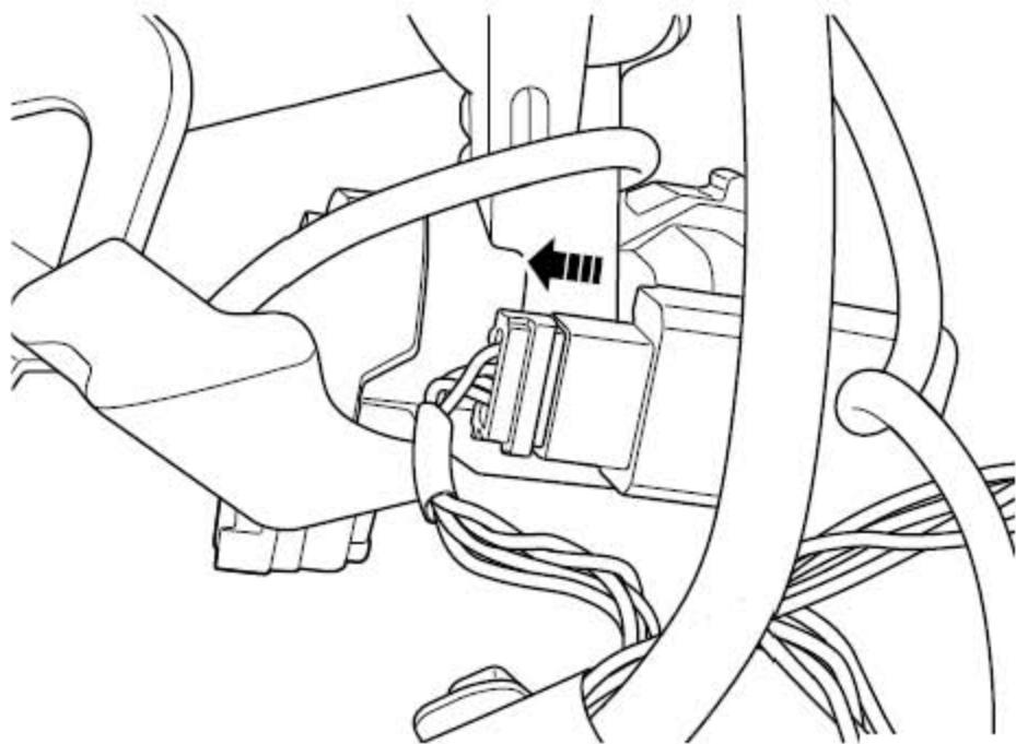
5). 断开电子防盗线圈线束连接器。
