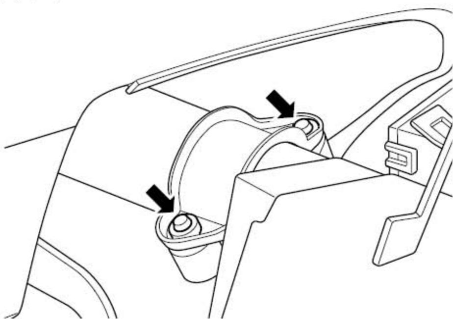
1). 安装点火开关并紧固固定螺栓。力矩: 17 Nm (公制) 12.6 1b-ft (英制)
