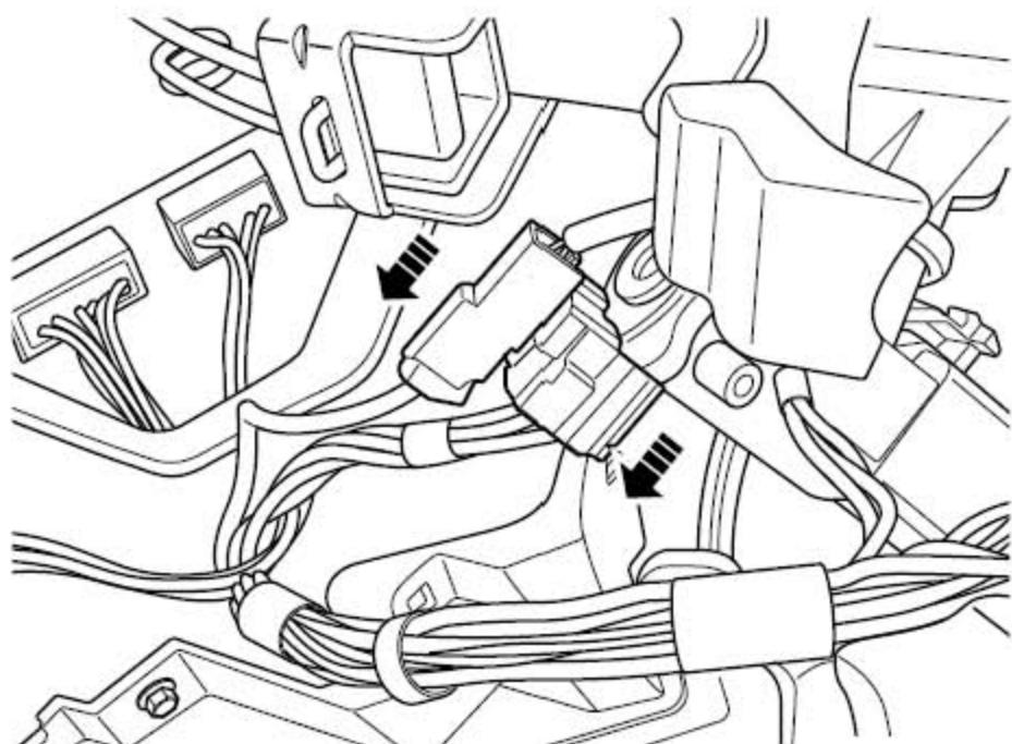
6). 分别断开钥匙忘拔开关、点火开关线束连接器。
