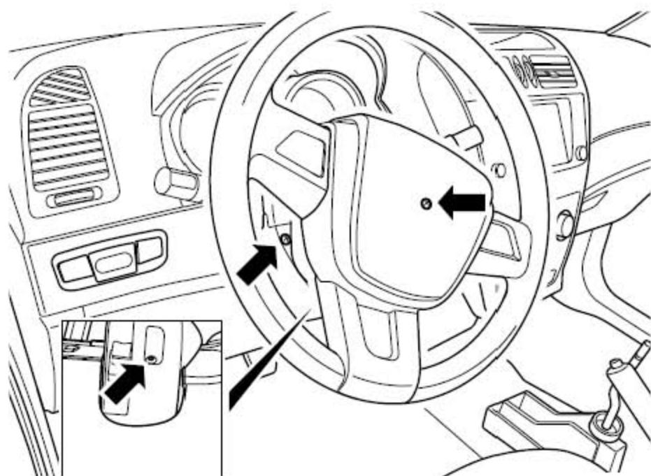
5). 安装转向柱上护板，并紧固左、右侧盖板螺钉。力矩: 8.8Nm(公制) 6.51b-ft (英制)
