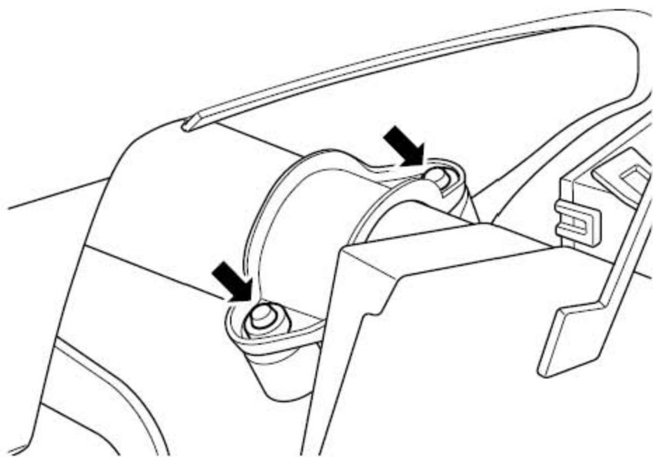
7). 使用合适的工具拆卸点火开关固定螺栓并废弃旧的螺栓。
