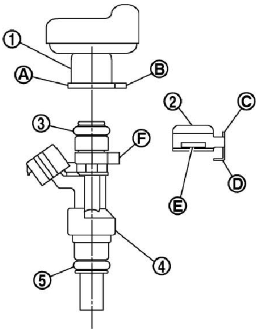
A). 将卡箍 (2) 插入燃油喷射器的卡箍固定槽内。
