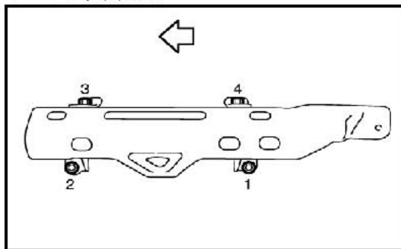
3). 拆下燃油喷射器和油管总成。
