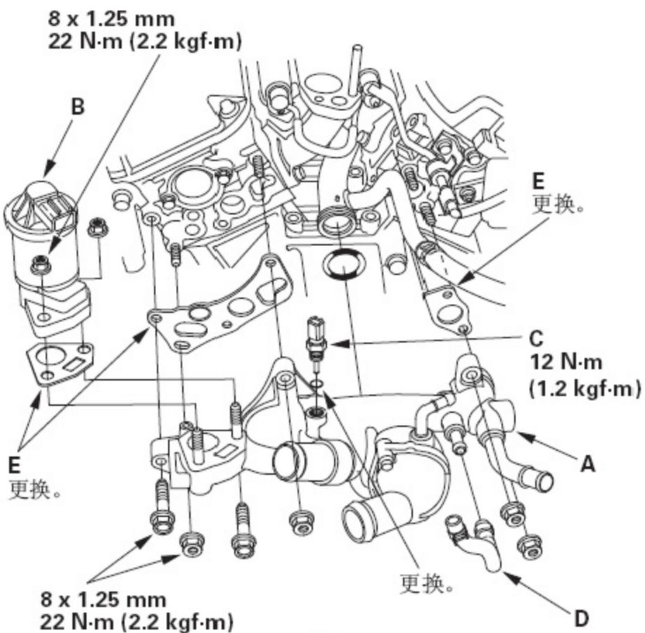
9) . 按照与拆卸相反的顺序用新衬垫(E) 安装冷却水通道。
