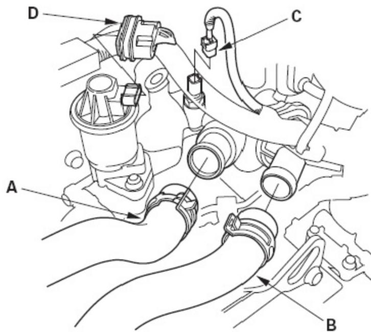
6) . 断开冷却水旁通软管 (A) 和加热器软管 (B)。
