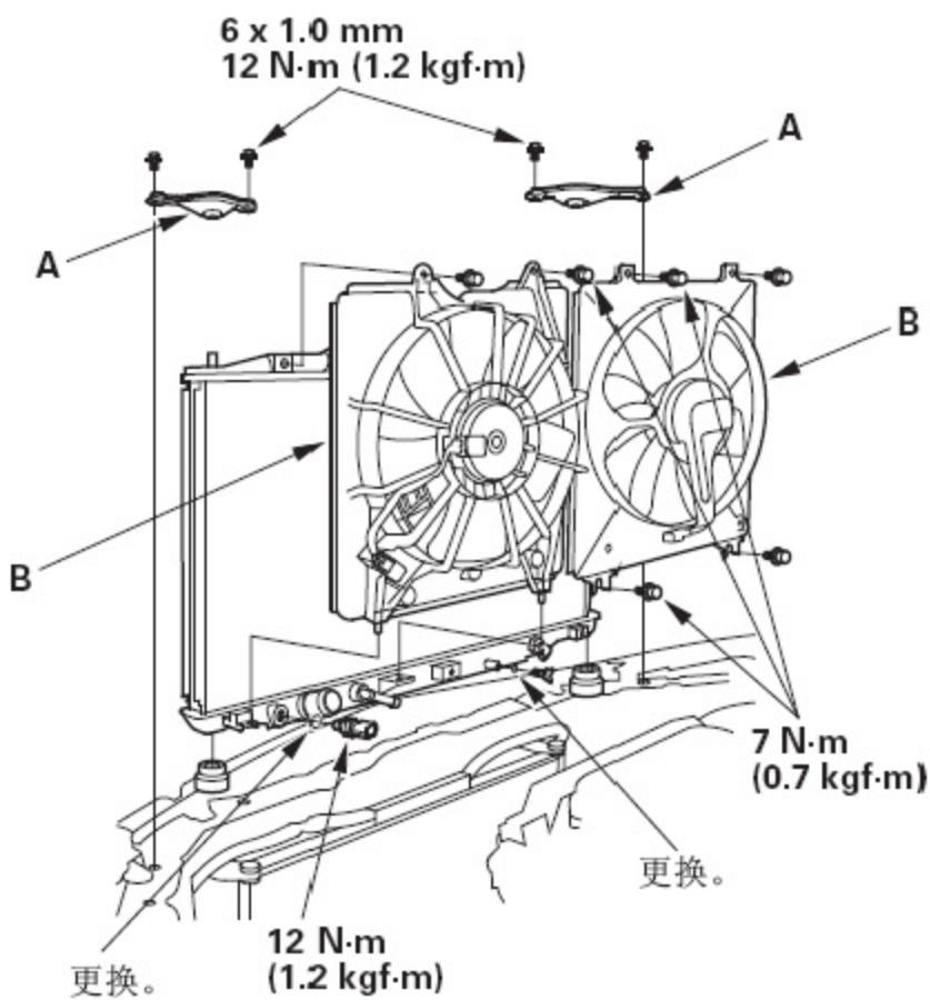
13). 将风扇护罩和其他零件从散热器上拆下。
