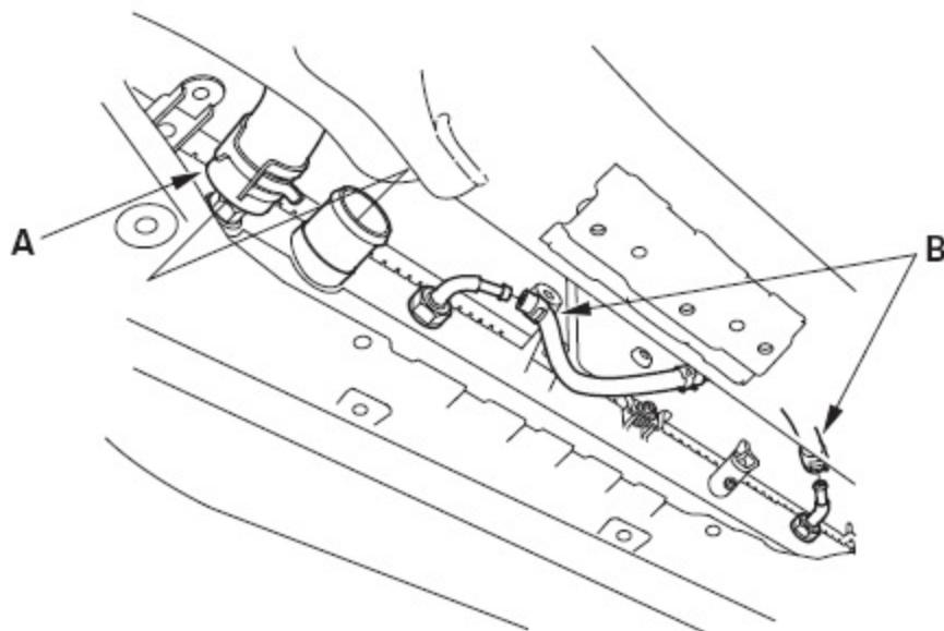
9) . 将自动变速器油(ATF) 冷却器软管(B) 从散热器上断开, 然后堵塞冷却器软管和管路。
