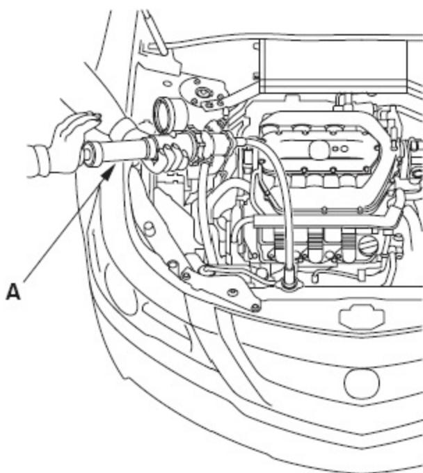
4) . 检查发动机冷却液是否泄漏和压力是否下降。
