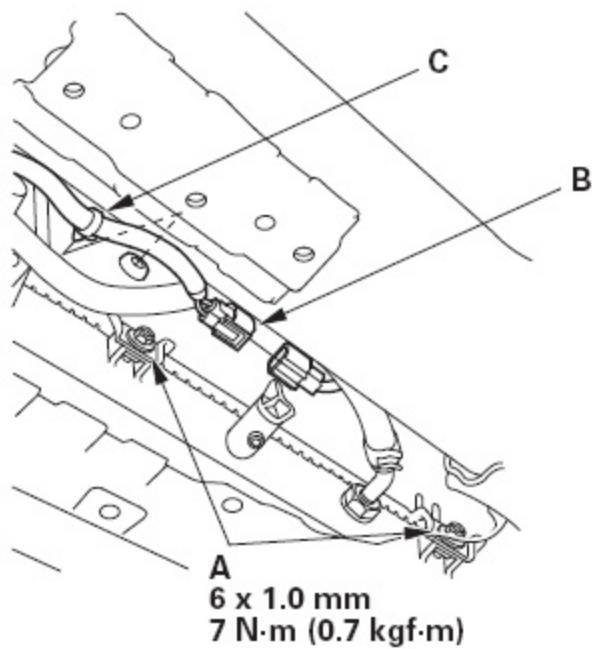
8) . 连接空调冷凝器风扇电机连接器(B)，并安装线束夹(C)。
