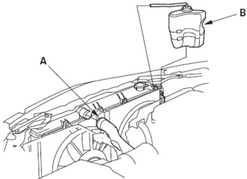
12). 拆下上托架(A), 然后向上拉带风扇护罩(B) 的散热器。
