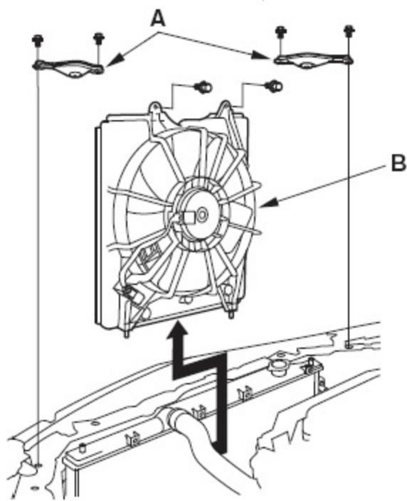
13). 拆下散热器风扇护罩总成(B)。
