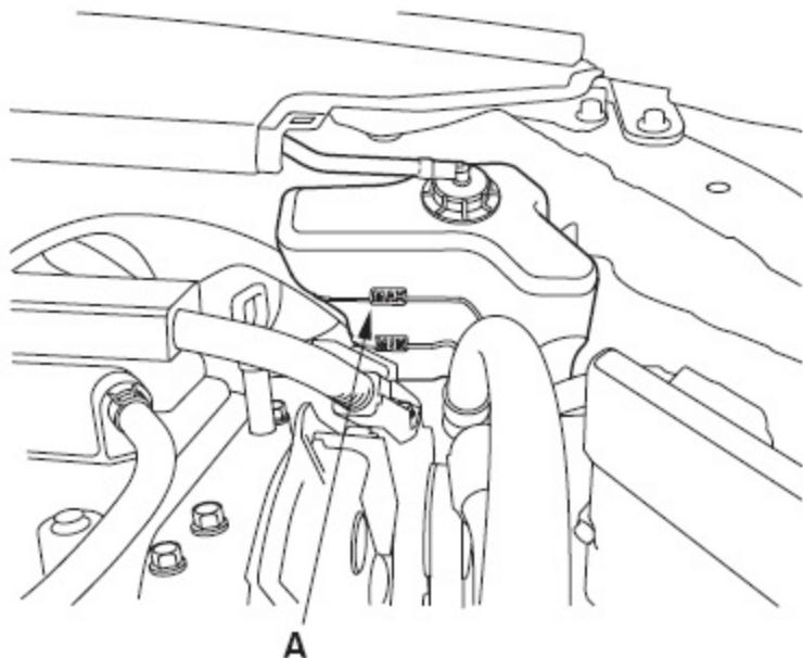
10). 用Acura 长效防冻剂/ 2 号冷却液加注散热器至注入口颈部底端处。
