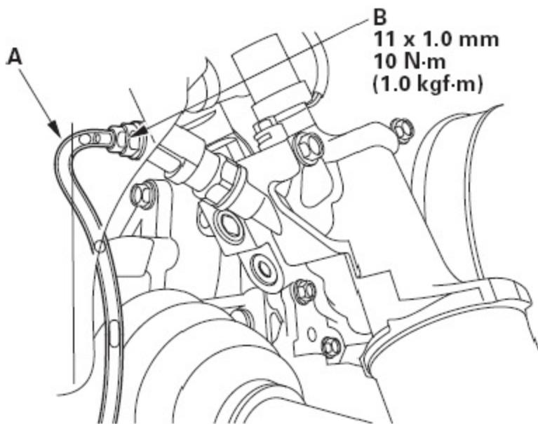
6). 冷却液停止排出时, 拧紧放液螺栓。拆下橡胶软管。
