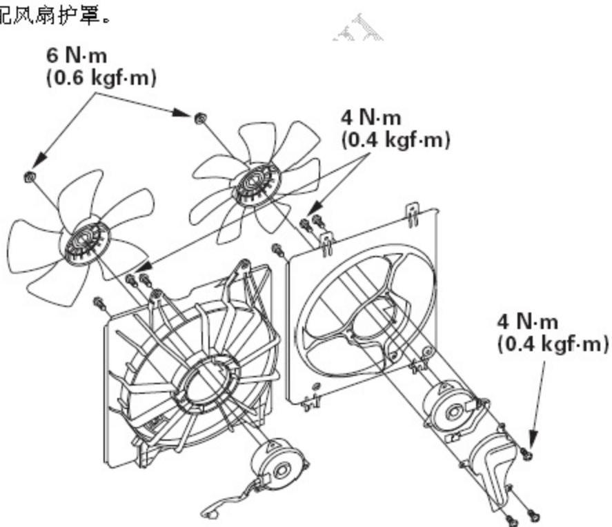
2) . 安装散热器风扇护罩总成(A)。
