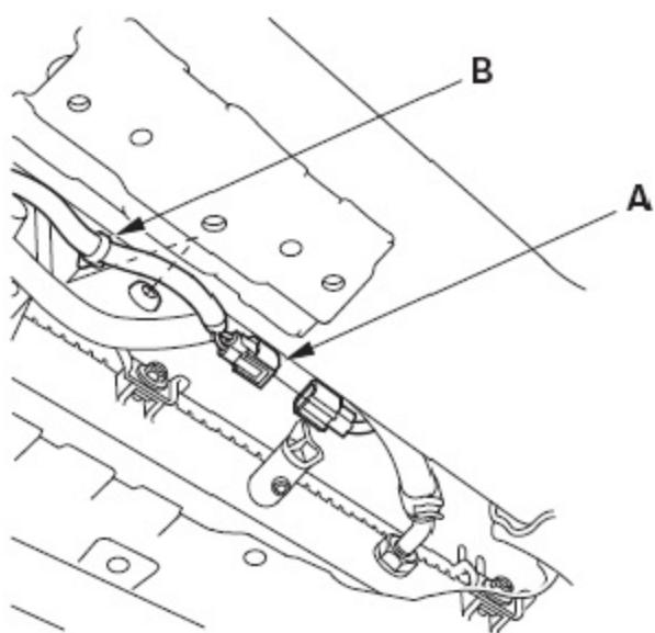
7) . 断开散热器风扇电机连接器(A) 和发动机冷却液温度(ECT)传感器2连接器(B), 然后拆下线束夹(C)。
