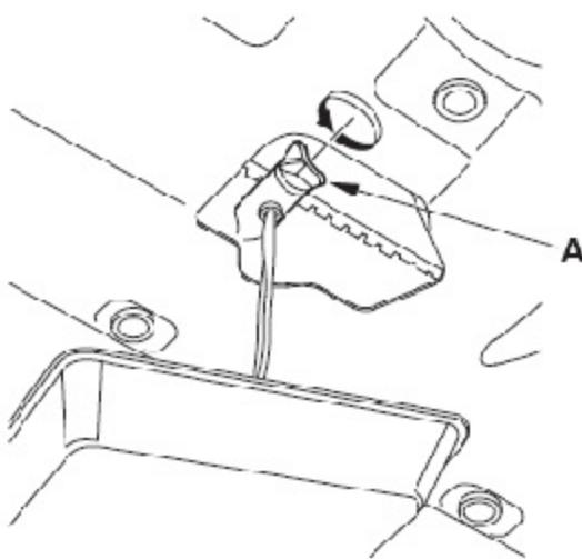
5). 将橡胶软管(A) 安装到位于发动机气缸体后部的放液螺栓(B) 上, 然后松开放液螺栓。
