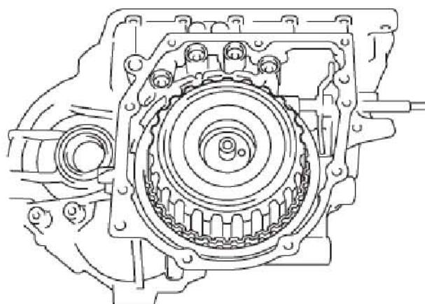
47). 安装2档滑行和超速制动器摩擦片
