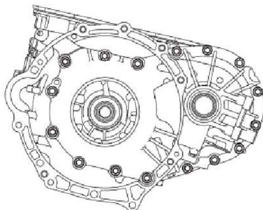
C). 用SST(专用工具)和小扭矩扳手，测量差速器齿轮的预紧力。
