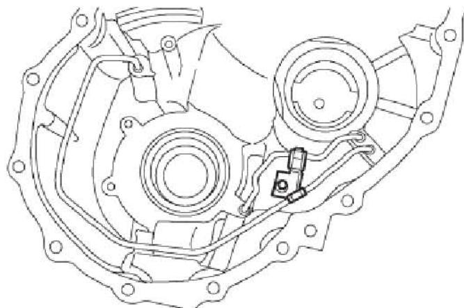
7). 安装变速器外壳变速器油分离器
