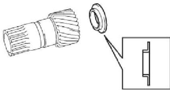
35). 安装行星太阳轮分总成
