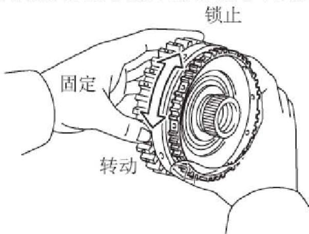
40). 安装行星齿轮后止推滚针轴承
