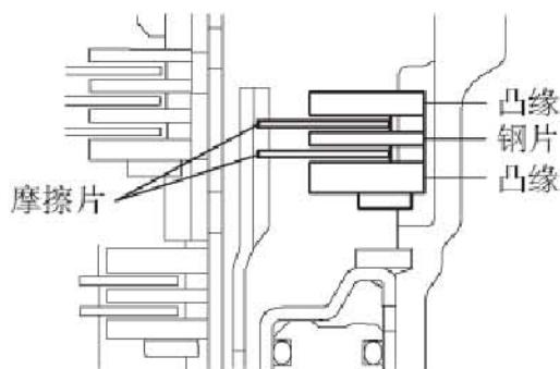
48). 检查2档滑行和超速制动器凸缘、摩擦片和钢片
