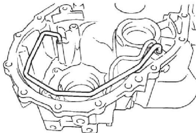
6). 安装1号变速器装配管夹箍
