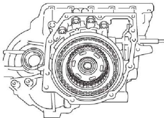
45). 安装太阳轮后止推轴承
