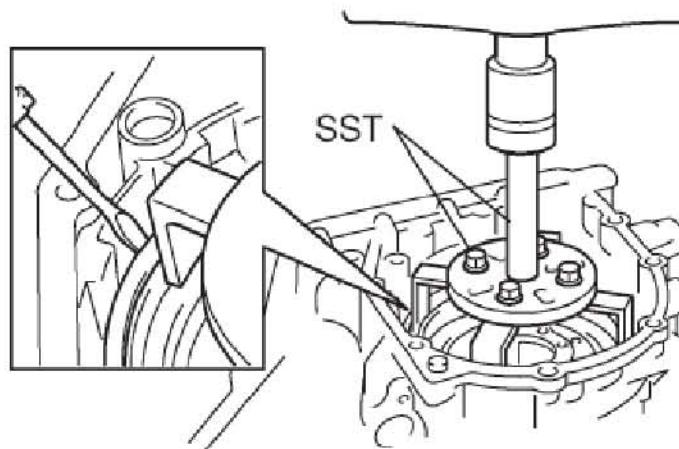
34). 安装前行星凸缘前止推轴承座圈
