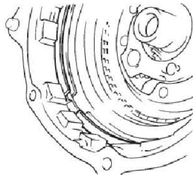
37). 安装行星齿轮架止推垫圈
