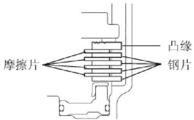
B). 用SST(专用工具)、压力器和螺丝刀安装卡环。
