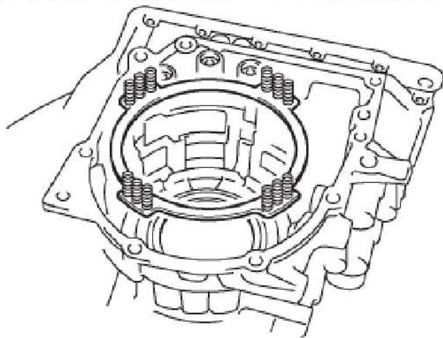
20). 安装1档和倒档制动器摩擦片
