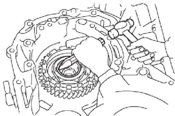
26). 安装行星齿轮总成
