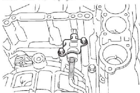
17). 安装1档和倒档制动器O形圈
