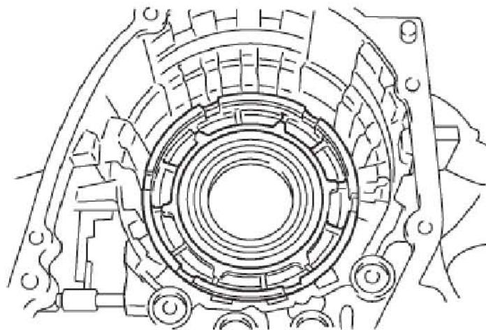
19). 安装1档和倒档制动器回位弹簧分总成
