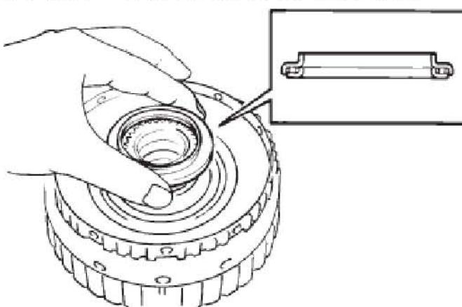
41). 安装后行星太阳轮总成
