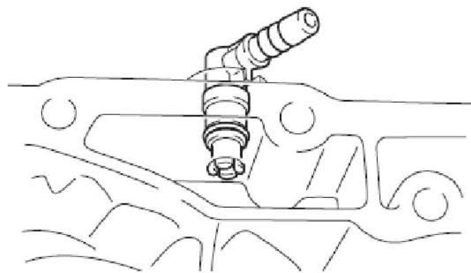
4). 安装差速器齿轮润滑油加注管
