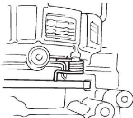
13). 安装手动锁止弹簧分总成
