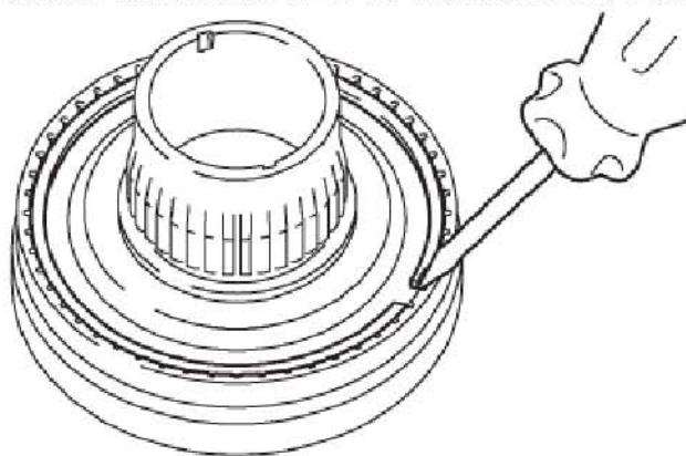
24). 安装行星齿圈凸缘
