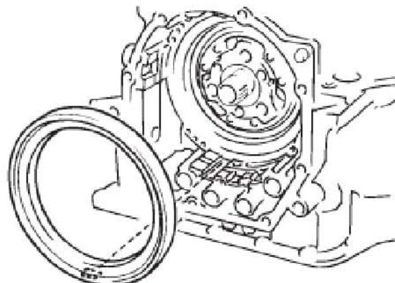
B). 用SST(专用工具)、压力器和螺丝刀，拆下卡环。
