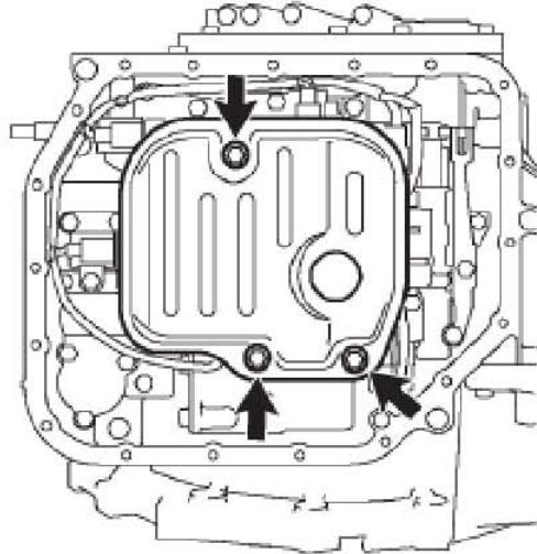
3). 安装自动变速器油底壳分总成
