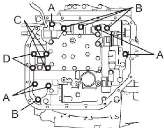
E). 暂时用2个螺栓安装手动锁止弹簧和手动锁止弹簧盖。
