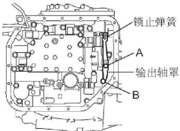
F). 检查并确认手动阀拉杆与锁止弹簧顶部的滚轮中心接触。
