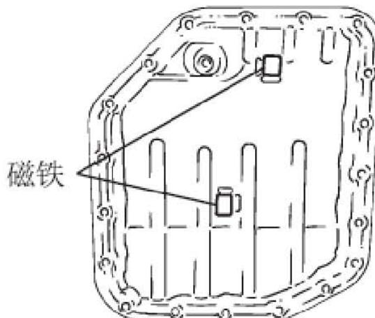
B). 用19个螺栓安装自动变速器油底壳分总成和新的油底壳垫片。
