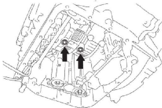
B). 安装止回球壳体弹簧和止回球壳体。
