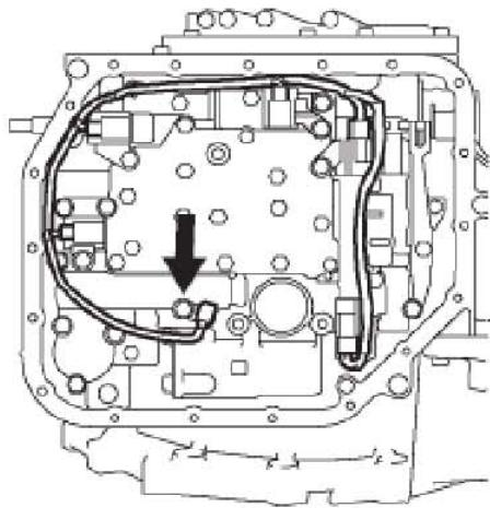
C). 拆下2个螺栓并拆下手动锁止弹簧盖和手动锁止弹簧。
