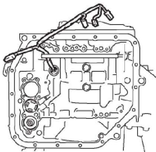
C). 用螺栓安装变速器线束。
