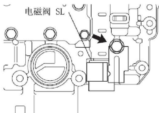
4). 拆卸3号电磁锁止板
