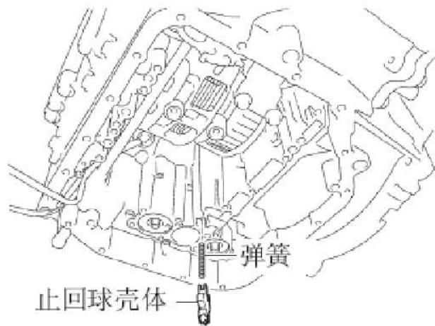
D). 暂时用13个螺栓安装变速器阀体总成。
