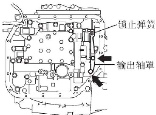
D). 拆下13个螺栓并拆下变速器阀体总成。
