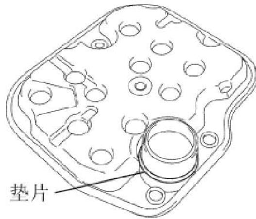
B). 用3个螺栓安装阀体滤油网总成。
