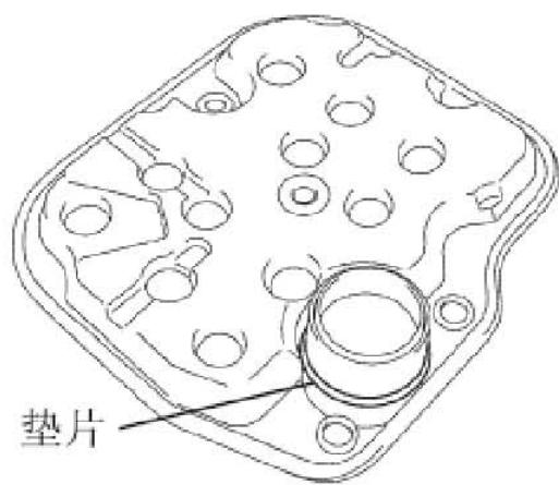
5). 拆卸变速器阀体总成
