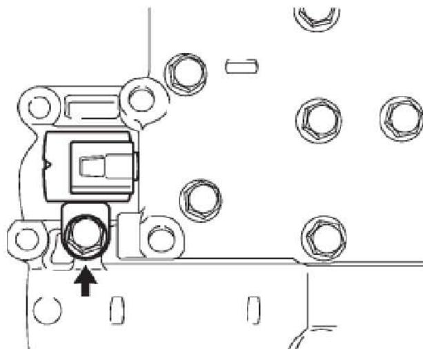
3). 拆卸换档电磁阀SL
