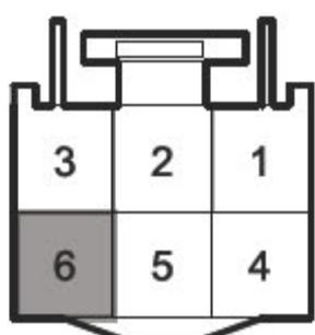
A). 连接万用表至点火开关线束连接器IP07 的6 号端子(注意：此测试不能断开IP07 线束连接器)。
