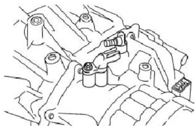
13). 拆卸螺栓和输出轴速度(OSS) 传感器。
