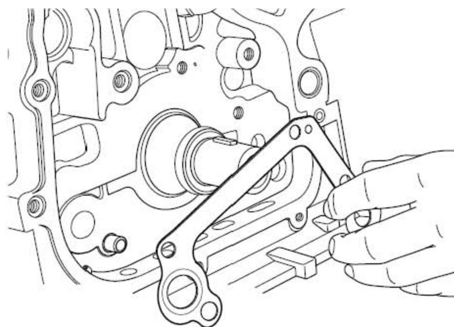
6). 从发动机缸体上取下机油泵衬垫。
