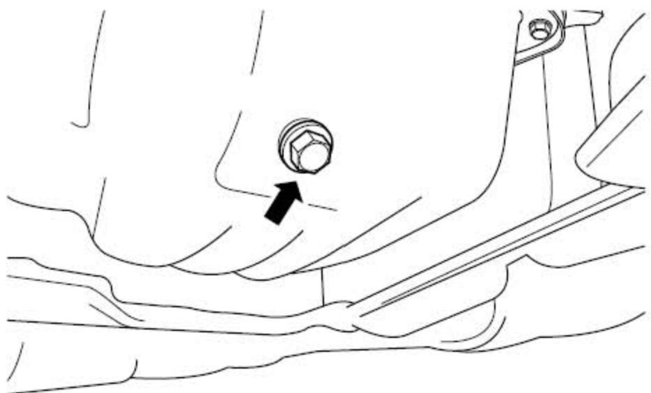
6). 安装并紧固油底壳放油螺栓。力矩: 30Nm(公制) 22.21b-ft(英制)
