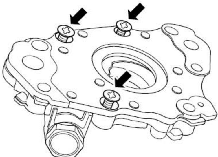
2). 拆卸机油泵后盖固定螺栓。
