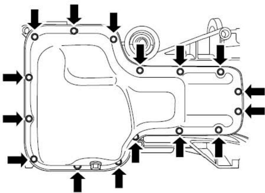
5). 拆卸油底壳固定螺栓及螺母。
