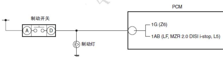
制动开关线束侧连接器
