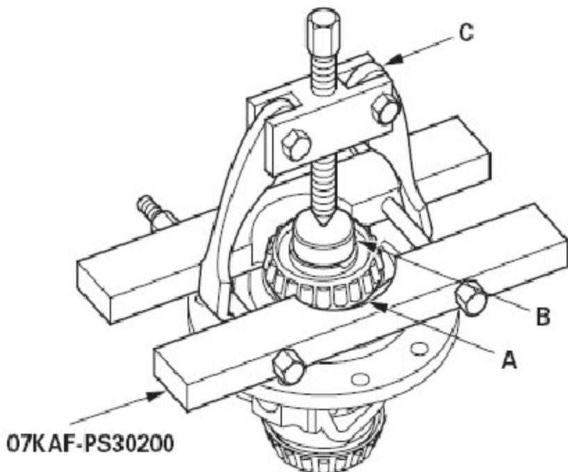
3). 将隔圈(B) 放在差速器托架上, 固定轴承拔出器(C), 然后拆下托架轴承。
