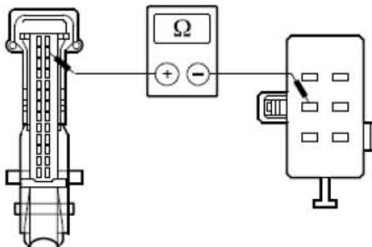
3). 检查介于右侧温度控制风门执行器与电子自动温度控制(EATC) 模块之间的回路是否开路。
