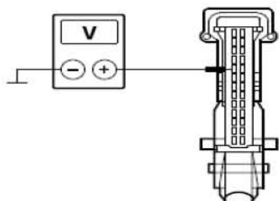
C). 测量介于 EATC 模块, 接头C2H101-A, 接脚10, 回路CH213A (BN/GN), 线束侧与搭铁之间的电阻。
