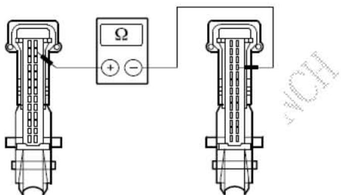
H). 测量介于 EATC 模块，接头C2H101-A，接脚10，回路CH213A (BN/GN)，线束侧与EATC模块，接头C2H101-A，接脚22，回路CH214A (GY/VT)，线束侧之间的电阻。
