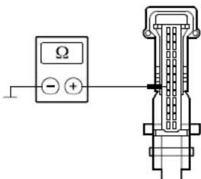
D). 测量介于 EATC模块，接头C2H101-A，接脚18，回路CH204A (GY/OG)，线束侧与搭铁之间的电阻。
