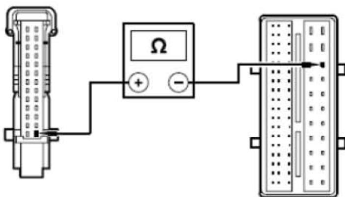
5). 检查 EATC 模块的搭铁连接。
