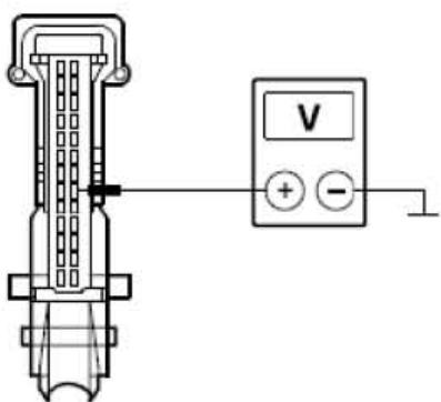
5). 检查介于空气分配风门执行器与EATC模块之间的回路是否与搭铁短接。
