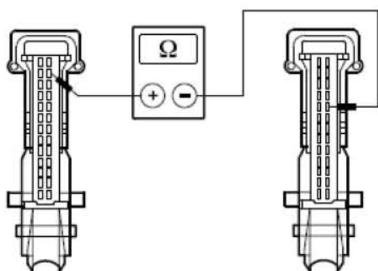
G). 测量介于 EATC 模块，接头C2H101-A，接脚25，回路CH211A (YE)，线束侧与EATC模块，接头C2H101-A，接脚23，回路CH215A (VT)，线束侧之间的电阻。
