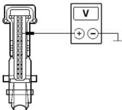
5). 检查介于右侧温度控制风门执行器与EATC模块之间的回路是否与搭铁短接。
