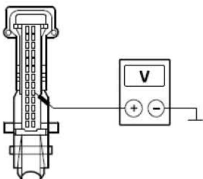
E). 测量介于 EATC模块，接头C2H101-A，接脚19，回路CH205A (BN/WH)，线束侧与搭铁之间的电压。
