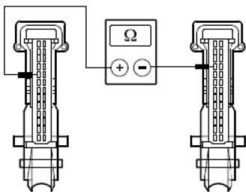
C). 测量介于 EATC 模块, 接头C2H101-A, 接脚9, 回路CH212A (BU/OG), 线束侧与EATC模块, 接头C2H101-A, 接脚22, 回路CH214A (GY/VT), 线束侧之间的电阻。
