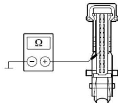
C). 测量介于 EATC模块，接头C2H101-A，接脚6，回路CH203A (GN/BN)，线束侧与搭铁之间的电阻。
