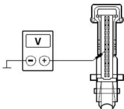
D). 测量介于 EATC模块，接头C2H101-A，接脚18，回路CH204A (GY/OG)，线束侧与搭铁之间的电压。
