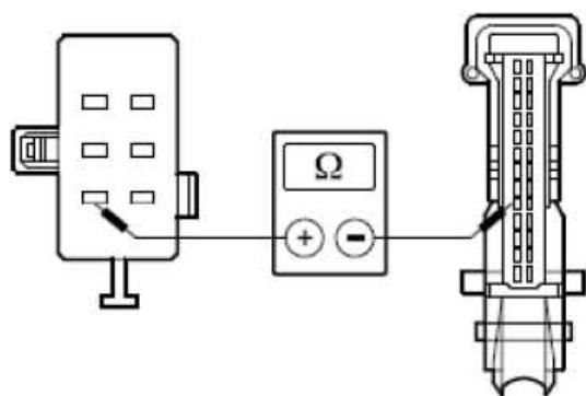
D). 测量介于 EATC模块，接头C2H101-A，接脚6，回路CH203A (GN/BN)，线束侧与空气分配风门执行器，接头C2H201，接脚3，回路CH203A (GN/BN)，线束侧之间的电阻。
