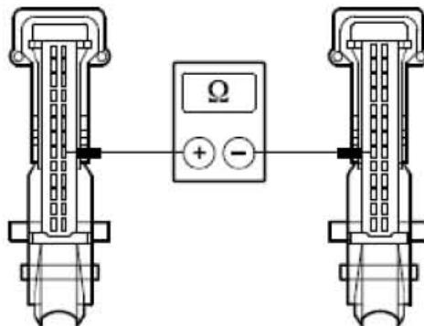
J). 测量介于 EATC模块，接头C2H101-A，接脚18，回路CH204A (GY/OG)，线束侧与EATC模块，接头C2H101-A，接脚19，回路CH205A (BN/WH)，线束侧之间的电阻。
