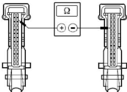
F). 测量介于 EATC 模块，接头C2H101-A，接脚25，回路CH211A (YE)，线束侧与EATC模块，接头C2H101-A，接脚22，回路CH214A (GY/VT)，线束侧之间的电阻。
