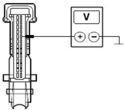
E). 测量介于 EATC 模块, 接头C2H101-A, 接脚23, 回路CH215A (VT), 线束侧与搭铁之间的电压。
