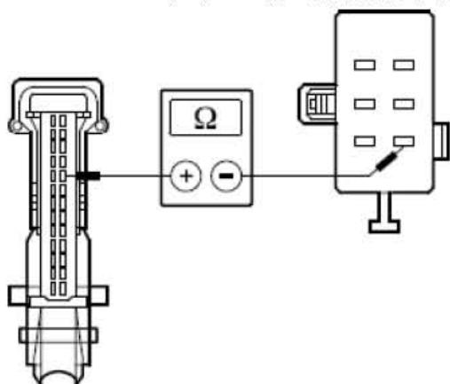
F). 测量介于 EATC 模块, 接头C2H101-A, 接脚23, 回路CH215A (VT), 线束侧与右侧温度控制风门执行器, 接头C6H211, 接脚6, 回路CH215A (VT ), 线束侧之间的电阻。
