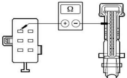
E). 测量介于 EATC 模块, 接头C2H101-A, 接脚22, 回路CH214A (GY/VT), 线束侧与右侧温度控制风门执行器, 接头C6H211, 接脚4, 回路CH214A(GY/VT ), 线束侧之间的电阻。
