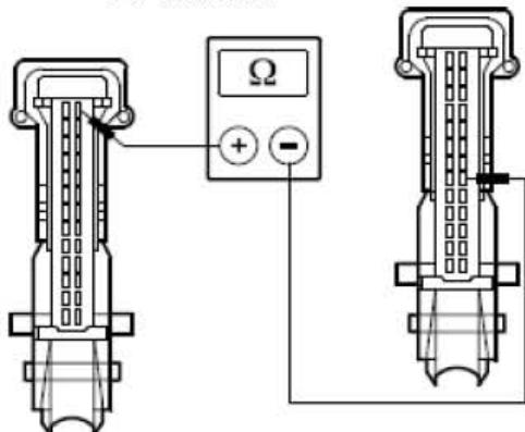
H). 测量介于 EATC模块，接头C2H101-A，接脚6，回路CH203A (GN/BN)，线束侧与EATC模块，接头C2H101-A，接脚18，回路CH204A (GY/OG)，线束侧之间的电阻。
