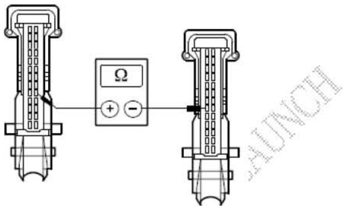
I). 测量介于 EATC模块，接头C2H101-A，接脚6，回路CH203A (GN/BN)，线束侧与EATC模块，接头C2H101-A，接脚19，回路CH205A (BN/OG)，线束侧之间的电阻。
