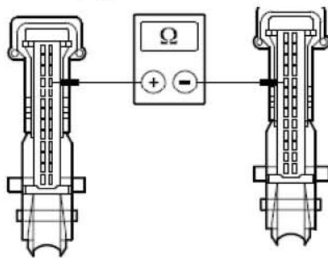
E). 测量介于 EATC 模块, 接头C2H101-A, 接脚25, 回路CH211A (YE), 线束侧与EATC模块, 接头C2H101-A, 接脚10, 回路CH213A (BN/GN), 线束侧之间的电阻。
