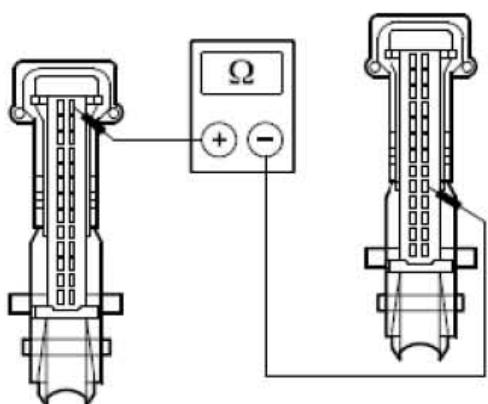
G). 测量介于 EATC模块，接头C2H101-A，接脚26，回路CH201A (YE/RD)，线束侧与EATC模块，接头C2H101-A，接脚19，回路CH205A (BN/WH)，线束侧之间的电阻。
