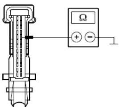
E). 测量介于 EATC 模块，接头C2H101-A，接脚23，回路CH215A (VT)，线束侧与搭铁之间的电阻。
