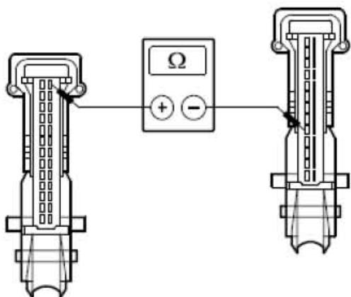
B). 测量介于 EATC模块，接头C2H101-A，接脚5，回路CH202A (BU/GN)，线束侧与EATC模块，接头C2H101-A，接脚6，回路CH203A (GN/BN)，线束侧之间的电阻。
