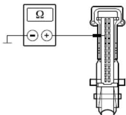
D). 测量介于 EATC 模块，接头C2H101-A，接脚22，回路CH214A (GY/VT)，线束侧与搭铁之间的电压。
