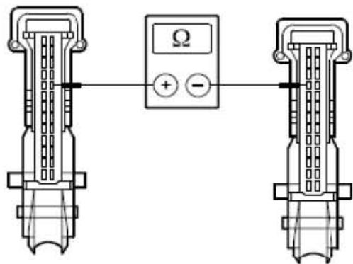
I). 测量介于 EATC 模块, 接头C2H101-A, 接脚10, 回路CH213A (BN/GN), 线束侧与EATC模块, 接头C2H101-A, 接脚23, 回路CH215A(VT), 线束侧之间的电阻。
