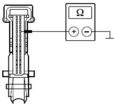
6). 检查介于右侧温度控制风门执行器与EATC模块之间的回路是否短接。
