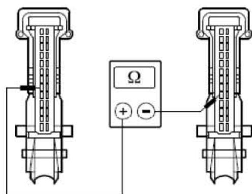
C). 测量介于 EATC模块，接头C2H101-A，接脚5，回路CH202A (BU/GN)，线束侧与EATC模块，接头C2H101-A，接脚18，回路CH204A (GY/OG)，线束侧之间的电阻。
