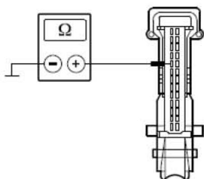
C). 测量介于 EATC 模块，接头C2H101-A，接脚10，回路CH213A (BN/GN)，线束侧与搭铁之间的电阻。
