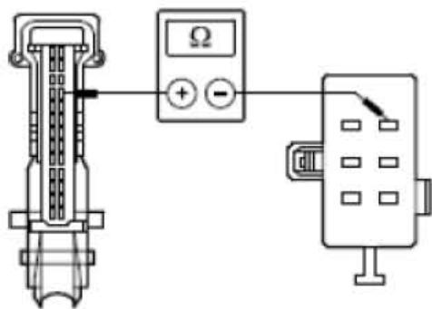
4). 检查介于右侧温度控制风门执行器与电子自动温度控制(EATC) 模块之间的回路是否与电源短接。
