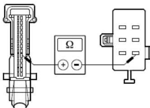
F). 测量介于 EATC模块，接头C2H101-A，接脚19，回路CH205A (VT/RD)，线束侧与空气分配风门执行器，接头C2H201，接脚6，回路CH205A (VT/RD)，线束侧之间的电阻。
