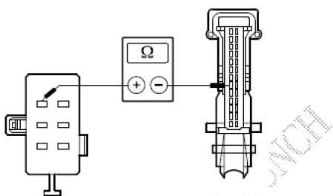
E). 测量介于 EATC模块，接头C2H101-A，接脚18，回路CH204A (GY/OG)，线束侧与空气分配风门执行器，接头C2H201，接脚4，回路CH204A(GY/OG)，线束侧之间的电阻。
