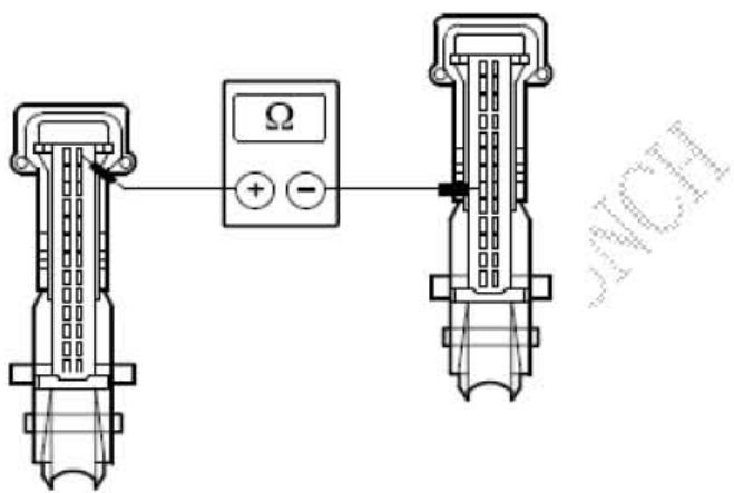
F). 测量介于 EATC模块，接头C2H101-A，接脚26，回路CH201A (YE/RD)，线束侧与EATC模块，接头C2H101-A，接脚18，回路CH204A (GY/OG)，线束侧之间的电阻。
