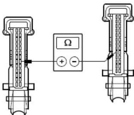
E). 测量介于 EATC模块，接头C2H101-A，接脚26，回路CH201A (YE/RD)，线束侧与EATC模块，接头C2H101-A，接脚6，回路CH203A (GN/BN)，线束侧之间的电阻。
