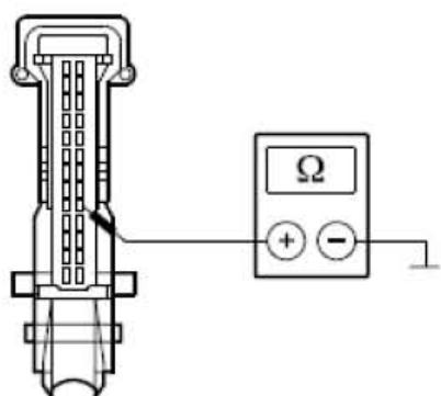
E). 测量介于 EATC模块，接头C2H101-A，接脚19，回路CH205A (BN/WH)，线束侧与搭铁之间的电阻。
