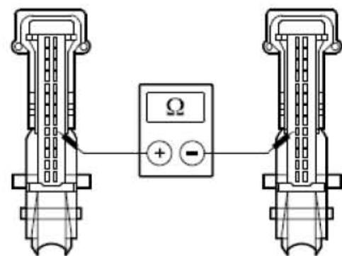
D). 测量介于 EATC模块，接头C2H101-A，接脚5，回路CH202A (BU/GN)，线束侧与EATC模块，接头C1MC40，接脚19，回路CH205A (BN/WH)，线束侧之间的电阻。
