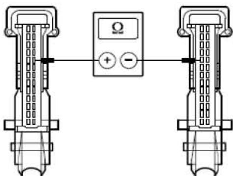
D). 测量介于 EATC 模块, 接头C2H101-A, 接脚9, 回路CH212A (BU/OG), 线束侧与EATC模块, 接头C2H101-A, 接脚23, 回路CH215A (VT), 线束侧之间的电阻。
