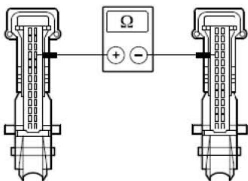
J). 测量介于 EATC 模块, 接头C2H101-A, 接脚22, 回路CH214A (GY/VT), 线束侧与EATC模块, 接头C2H101-A, 接脚23, 回路CH215A(VT), 线束侧之间的电阻。
