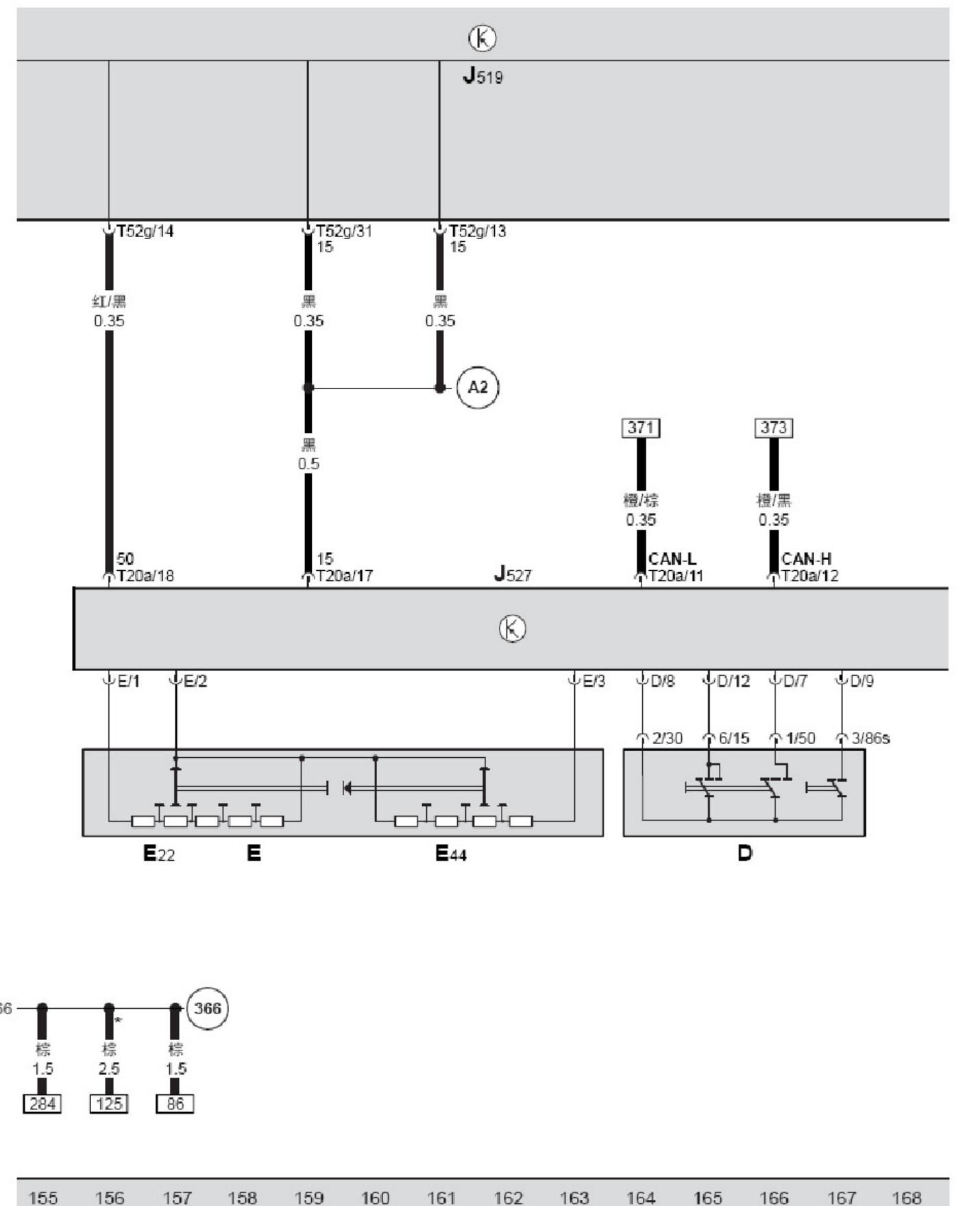
BCM 车身控制单元、转向柱电子装置控制单元、车窗玻璃刮水器开关、间歇式刮水器运行开关、车窗玻璃清洗泵开关（清洗刮水自动装置和大灯清洗装置）、点火起动开关
