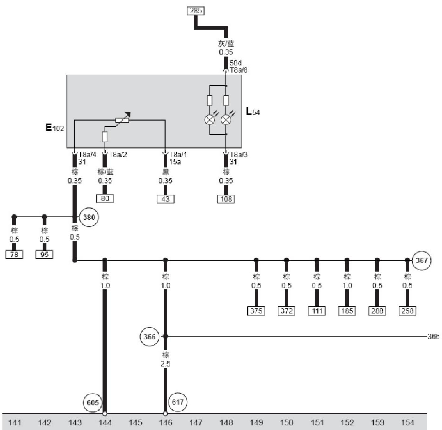
E102 — 大灯光线水平调整调节器，在仪表板左侧出风口下方，
