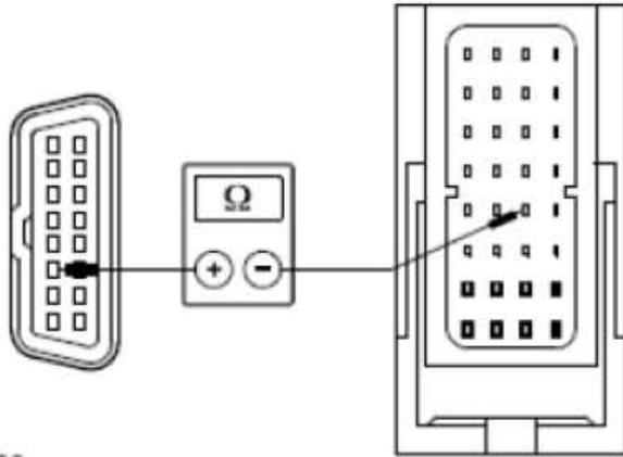
67). 检查动力控制模块 (PCM) 的电压
