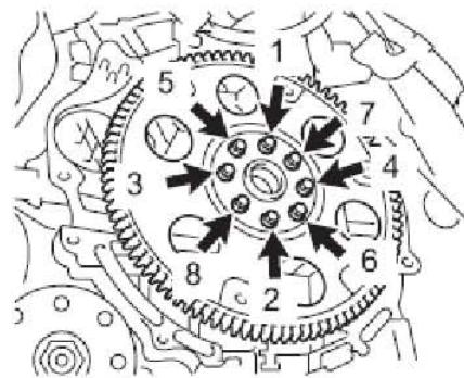
3). 安装自动变速器总成
