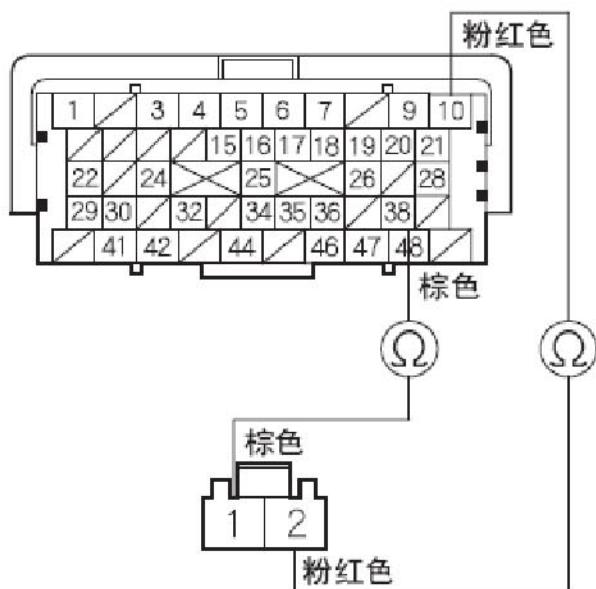
**蒸发温度传感器 2 针插接器**
