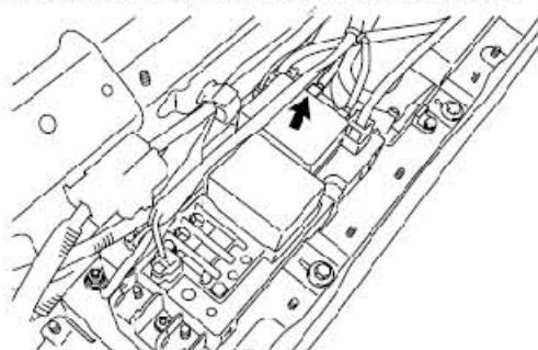
结果：连接器牢固连接且无接触故障。
