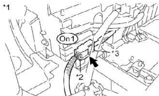
正常：连接器牢固连接且无接触故障。
