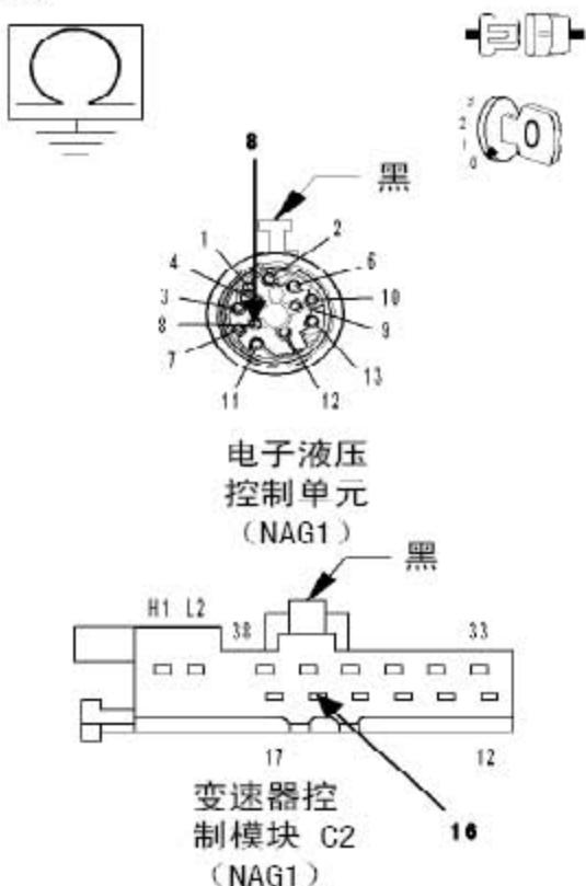
4). 检查（T74）2-3 档电磁阀控制电路是否对其它电路短路
