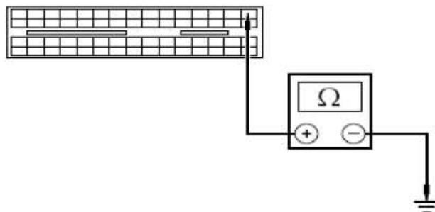
9). 检查DTC P0758 换档电磁阀B 的故障并维修
