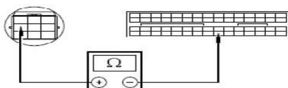
7) . 检查主控制阀连接头电路是否对电源短路
