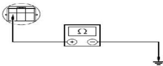
3) . 检查换档电磁阀D连接头状况
