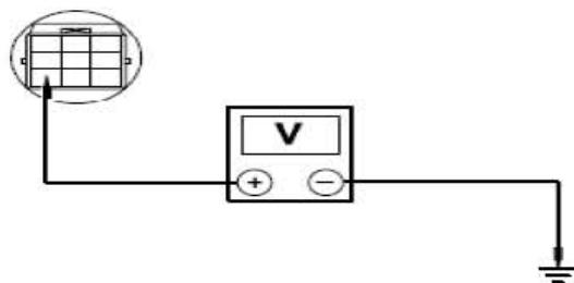
8). 检查PCM电路是否搭铁短路
