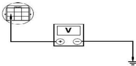
8) . 检查PCM电路是否搭铁短路
