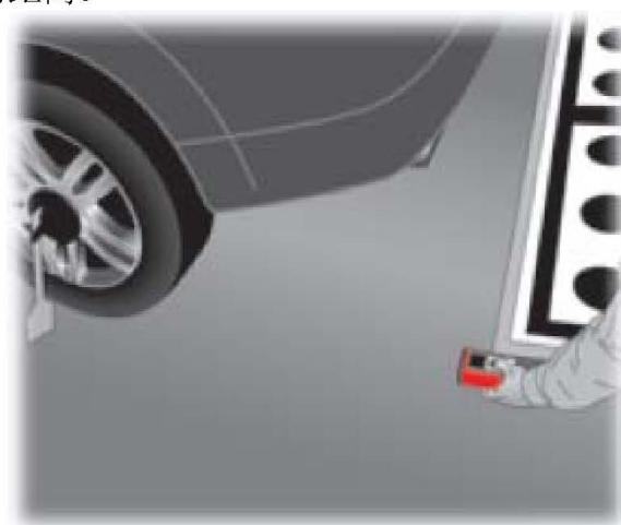
3). 现在利用位于校准面板中央的激光划线装置，把校准面板与汽车中心纵轴对准，但不要改变已经设置好的间距。激光在车尾形成一条垂直的虚线，如果面板已经正确对准，车尾的奥迪徽标会正好被激光线分为两等份。
