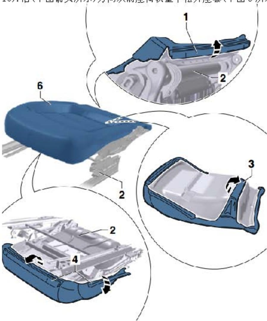
17). 沿(下图箭头所示)方向向上卷起前座椅软垫(下图 2 所示)的外侧座套(下图 1 所示)的四边。
