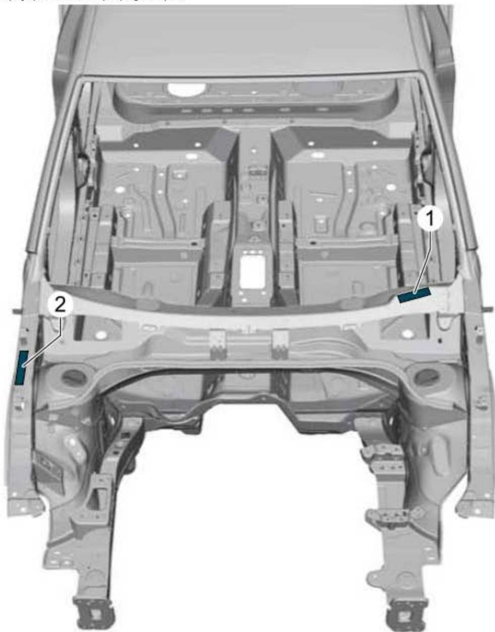
1). 挡风玻璃框架左下侧上的车辆识别号
