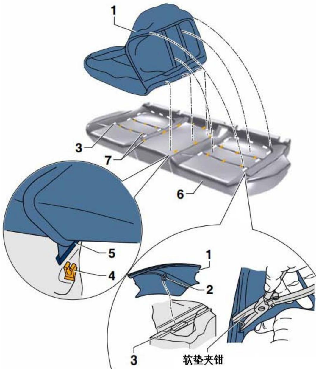
5). 用软垫夹钳将座套四周用新的软垫夹(下图箭头所示)固定到座椅框架上。
