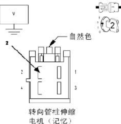
9). (P953) 转向管柱伸缩电机公用电路对地短路
