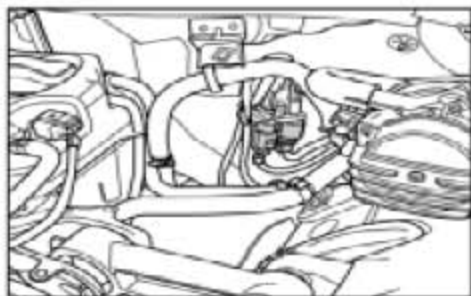
放水板处的氧传感器接头
