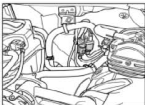
将氧传感器的接头连接在防溅板上
