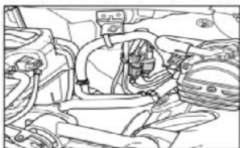
断开防溅板上的氧传感器插头并松开支架上的拉线
