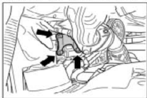
催化转化器托架上的紧固螺钉
