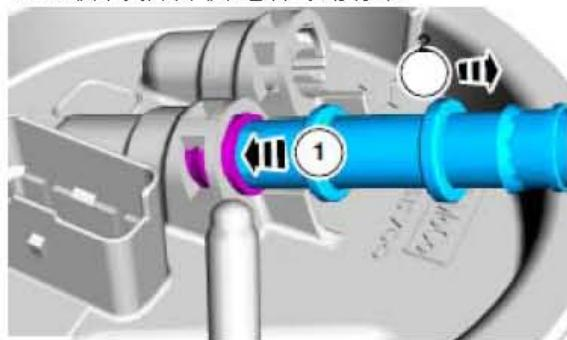
10). 使用合适的平片螺丝起子释放油管快速释放接头的第二锁定舌片。
