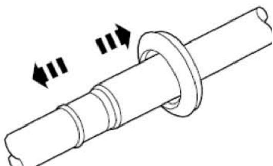
4) . 簧锁定接头，并听到滴答声。将弹簧锁定接头安装到油管上。
