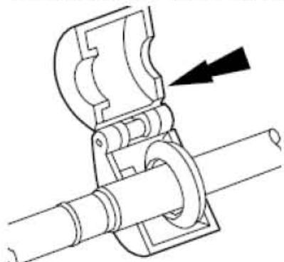
8). 关闭油管弹簧锁定接头工具，并将其推入保持架的开口侧。
