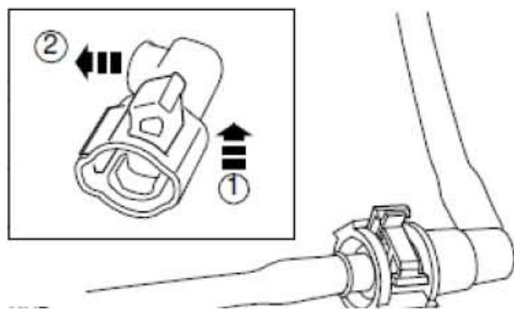
9). 安装油管快速释放接头。
