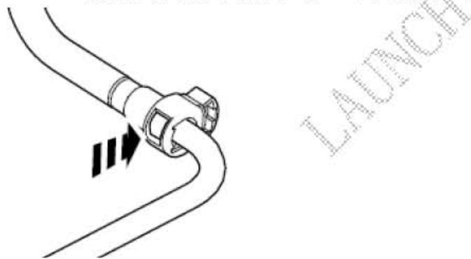
12). 从油管快速释放接头上拆开油管。
