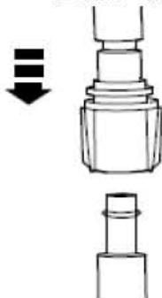
8). 安装油管快速释放接头。
