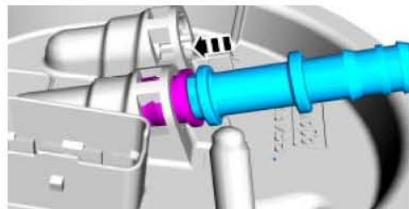
9). 拆开油管快速释放接头。
