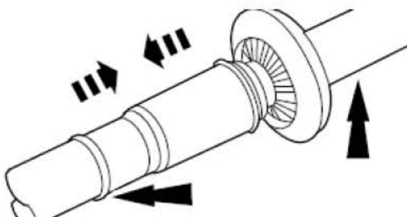
3) . 确保通过拉动管路使油管弹簧锁定接头接合。
