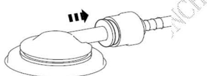
7) . 拆开燃油箱排油管快速释放接头。
