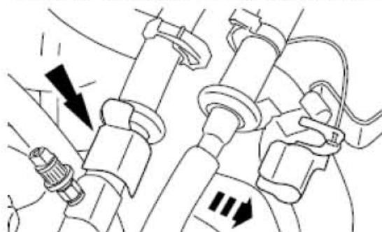
7). 将专用工具安装到油管弹簧锁定接头上。
