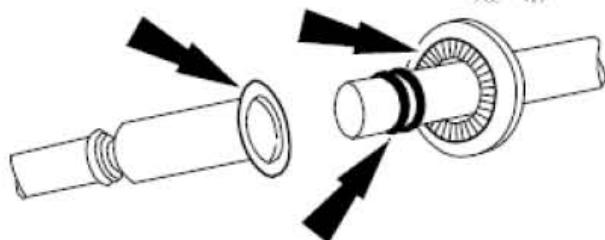
2). 将阳螺纹管接头插入承口端，并推动直至卡紧弹簧咬紧阴螺纹管接头的扩口。
