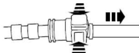
6) . 释放燃油箱排油管快速释放接头。
