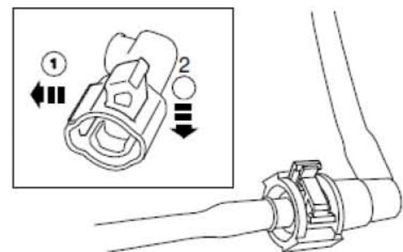
4) . 拆开油管快速释放接头。
