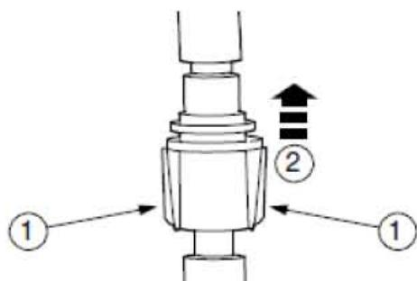
5) . 拆开油管快速释放接头。
