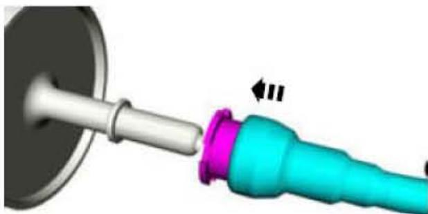
2). 将油管安装至油管快速释放接头。
