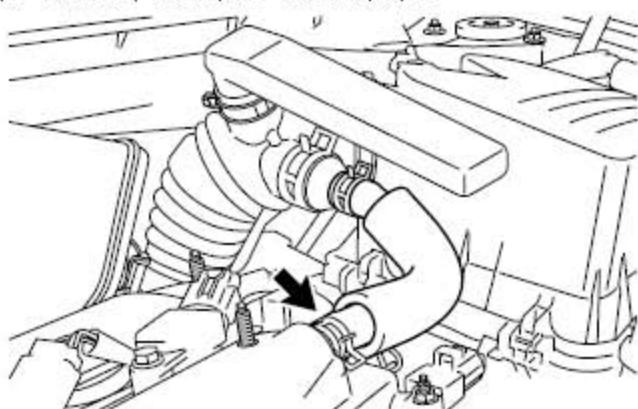
G). 锁止1号空气滤清器软管卡夹，然后从节气门体上断开1号空气滤清器软管。
