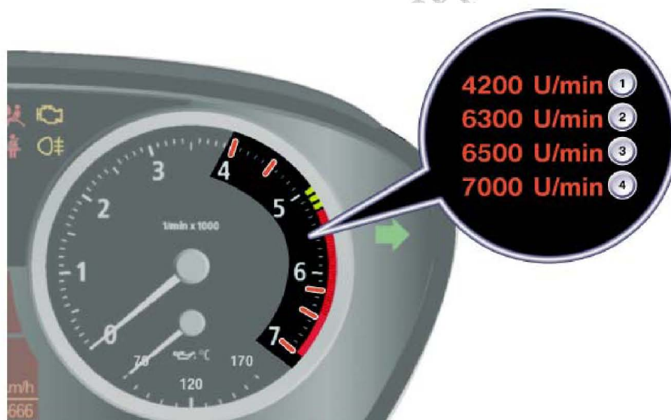
汽油发动机 E63 转速表的警示区
