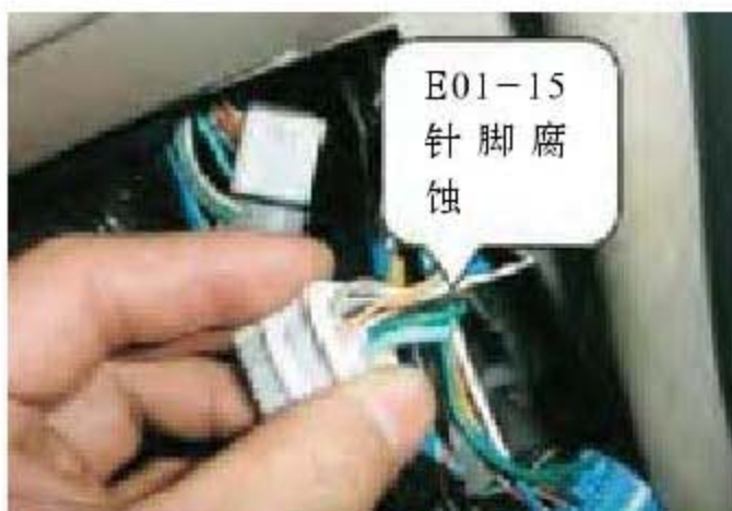
图2 E01连接器针脚腐蚀
