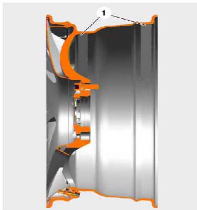
图 15: 带装饰罩的轻合金结构锻造车轮横断面
