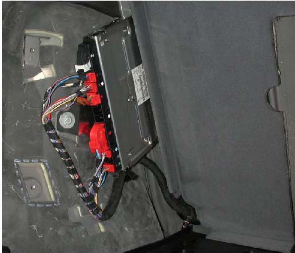
图 63: 左侧舒适型后座椅的座椅控制单元
