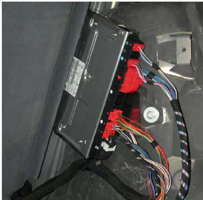
图 64: 右侧舒适型后座椅的座椅控制单元
