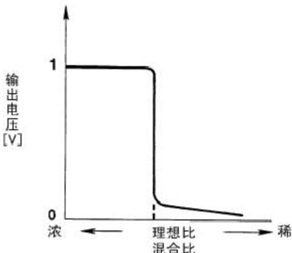
加热型氧传感器安装在排气歧管里面。它能检测排放出的废气中含氧量。加热型氧传感器由一只由氧化锆陶瓷制成的闭锁式的管子。氧化锆会产生电压，在氧气充足时大约为 1V，而在含氧稀薄时减小到0V。加热型氧传感器 1 的信号发送给 ECM。ECM 调整喷油脉冲的占空比，以得到理想的空燃比。电压在 1V 到 0V 之间变化时，空燃比为理想空燃比。
